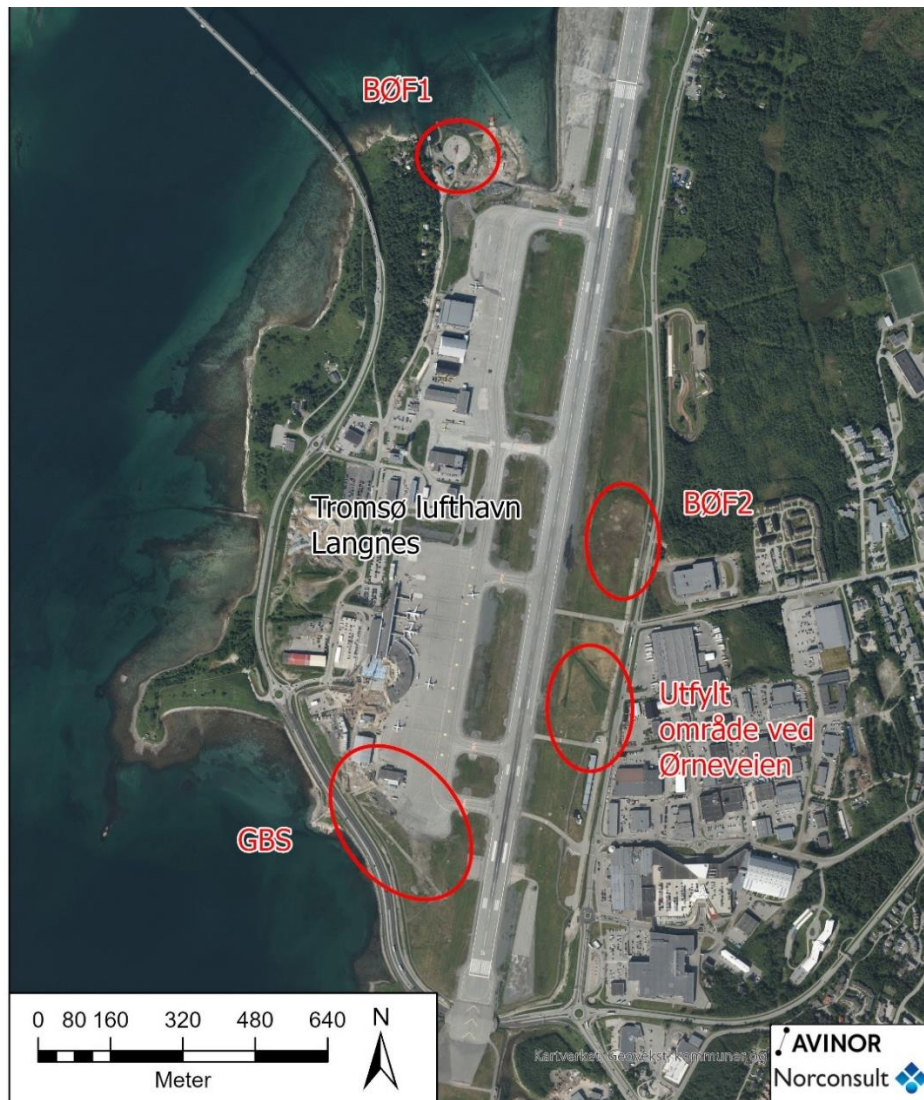
Figur 1-1: Lokalisering av Tromsø lufthavn Langnes. De fire hovedkildene til spredning av PFAS fra lufthavnen er vist i kartet; sist nedlagt brannøvingsfelt (BØF1), gammelt brannøvingsfelt (BØF2), gammel brannstasjon og deice-området (GBS), samt utfyllt område ved Ørneveien (UOØ).
