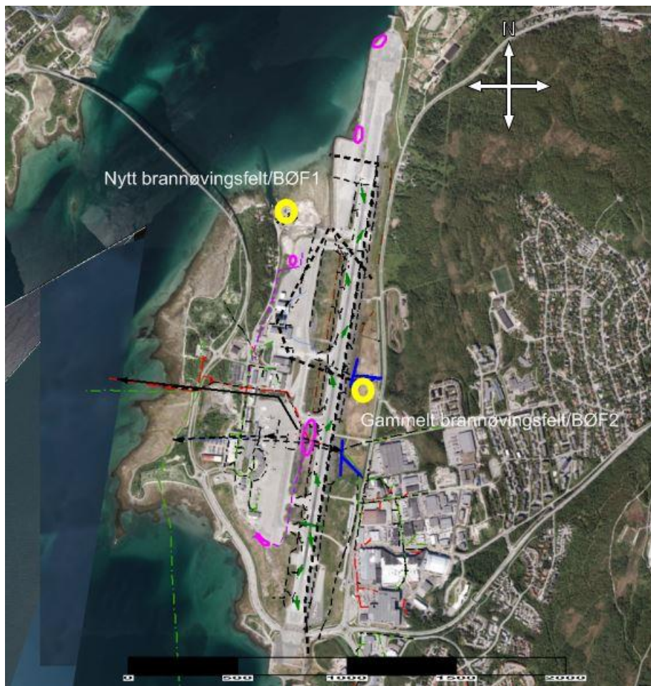
Figur 7-2. Grøfter og overvannsledninger på Tromsø lufthavn vises med sort. Rosa sirkler er snødeponier. Grønne piler viser retning avrenning fra rullebanen. Grønn stiplet linje er spillvann. Rød strek er avløp. Brun stiplet strek er drens vann. BØF1 og BØF2 er vist med gule sirkler.
