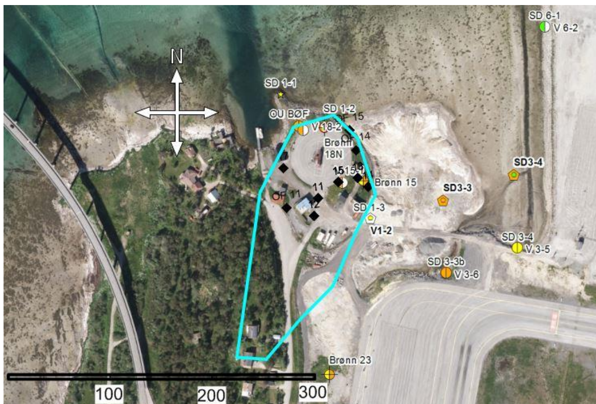
Figur 7-10. Viser nedbørsfelt til BØF1 og området rundt med lyseblått polygon. Jordprøvepunkter er markert med sorte punkter. Sirkel markert med kryss er brønner. Sirkel med lodrett strek er prøver av overflatevann. Venstre side av sirkel har fargekode for PFOS-klasse, mens høyre side av sirkel har fargekode for PFAS-klasse. Stjerneformet symbol viser prøver av marine sedimenter (PFOS), femkantet symbol viser sjøvannsprøver. Indre femkant har fargekode for PFOS-klasse og ytre femkant har fargekode for PFAS-klasse. Klassifiseringen er basert på gjennomsnittsverdier for målingene som er gjort i punktet.
