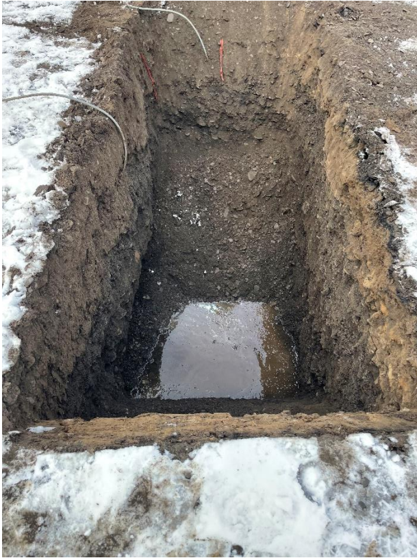
Figur 2-2: Bilder fra prøvetaking i to sjakter (SJ71 og SJ72) inne på hestegård. Det var grove, sand- og grusholdige masser i hele dybden, med vanninnsig over permafrost.
