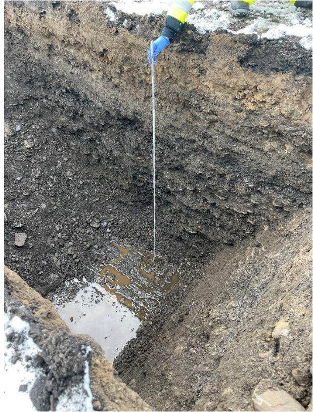
Figur 2-2: Bilder fra prøvetaking i to sjakter (SJ71 og SJ72) inne på hestegård. Det var grove, sand- og grusholdige masser i hele dybden, med vanninnsig over permafrost.
