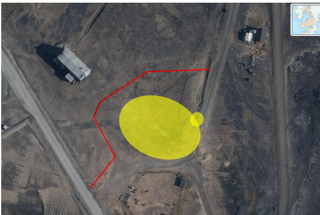
Figur 1: Planlagt linje for midlertidig plassering av anleggsgjerdet for å redusere risiko for negativ påvirkning av ternenes hekkesuksess basert på innhentede GPS koordinater under befaring er angitt med rød strek. Gul sone angir ternekoloniens utbredelse ( www.toposvalbard.npolar.no ).
