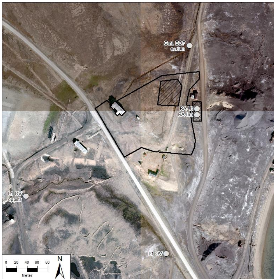
Figur 7-1: Prøvepunkter for overvåkning av sigevann og resipient, samt for kontroll av vannrenseanlegg.
