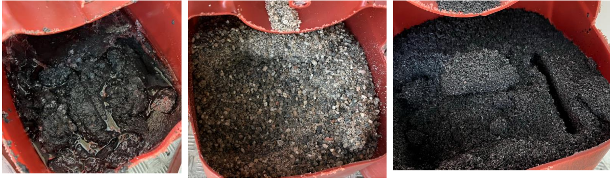
Figur 1: Bildene viser fra venstre til høyre: slam, sandfilter og kullfilter.
