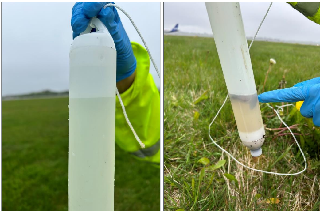
Figur 3-3: T. v.: eksempelbilde av prøvetaking med bailer (brønn 988). T. h.: bilde fra prøvetaking av brønn 985 hvor det var for lite vann til representativ analyse.
