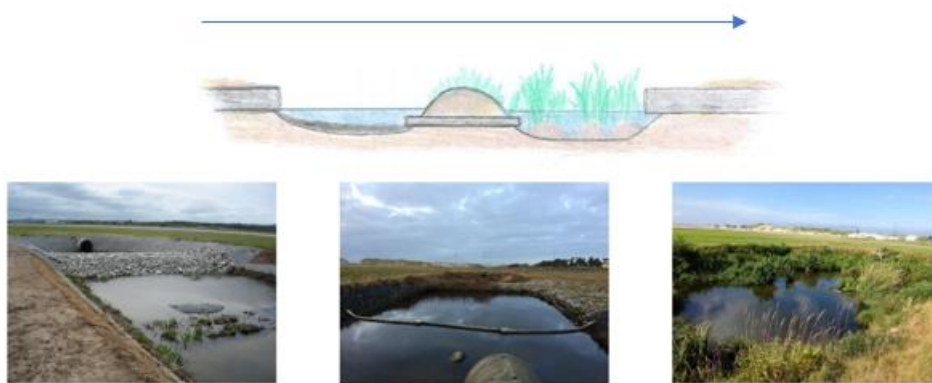
Figur 5: Skisse og bilder av Avinors rensedam på Sola. Pilen viser vannets retning gjennom rensedammen. Figur fra Avinor/ Ingvald Erga.
