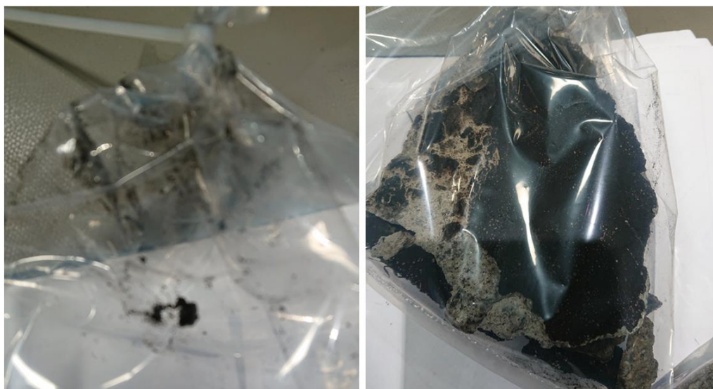
Figur 18: Betongnedfall med sot fra taket og svært små rester (slim) av brannskum fra parkeringshuset 17.01.2020.
