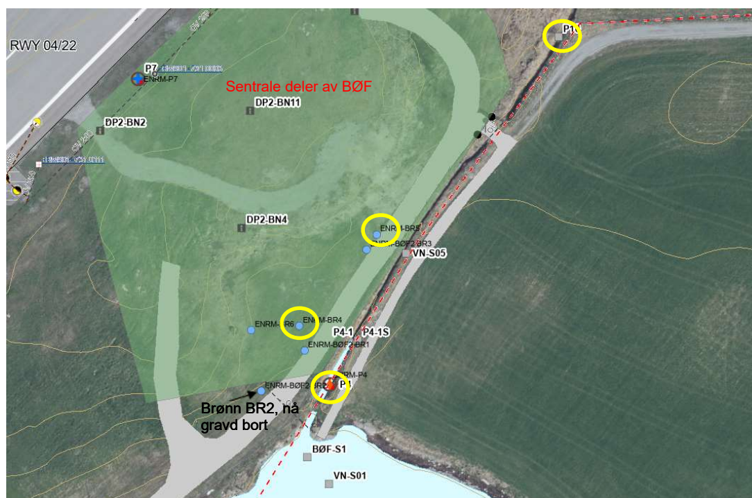
Figur 4 Plassering av brønner nedstrøms BØF 2 og prøvepunkter i bekk/grøft oppstrøms BØF 2 (P10) og nedstrøms avrenning fra BØF2. Gule sirkler viser plassering av prøvepunkter i overvåkingsprogram etter tiltak. Grønt skravert område viser tiltaksområdet som ble masseutskiftet (dette er foreløpig noe større på figur enn faktisk gravd ut, venter på nye innmålinger)
