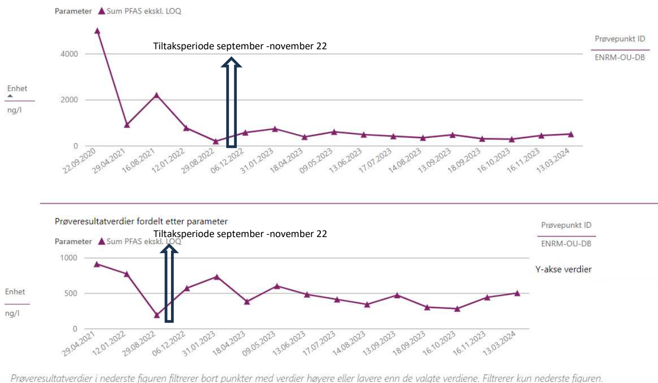
Figur 5 Påvist Sum PFAS og PFOS (ng/l) i oljeutskiller ENRM-OU. Nederste figur har ikke med høyeste målinger i 2020-2021 for bedre lesbarhet for siste års utvikling
