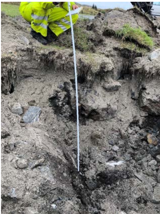
Figur 4-3: Bilder av masser sentralt på BØF 2 (SJ1 på bilder øverst og SJ6 på bilder nederst). Massene består i hovedsak av organisk rik jord over fyllmasser (hovedsakelig sprengstein iblandet skjellsand), eller naturlige masser av silt/leire.
