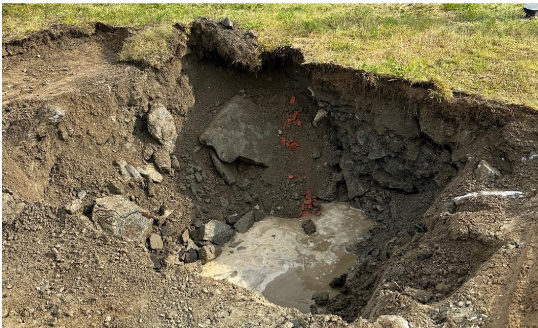
Figur 5-1: Eksempel på fyllmasser sentralt på BØF, her fra punkt SJ12.
