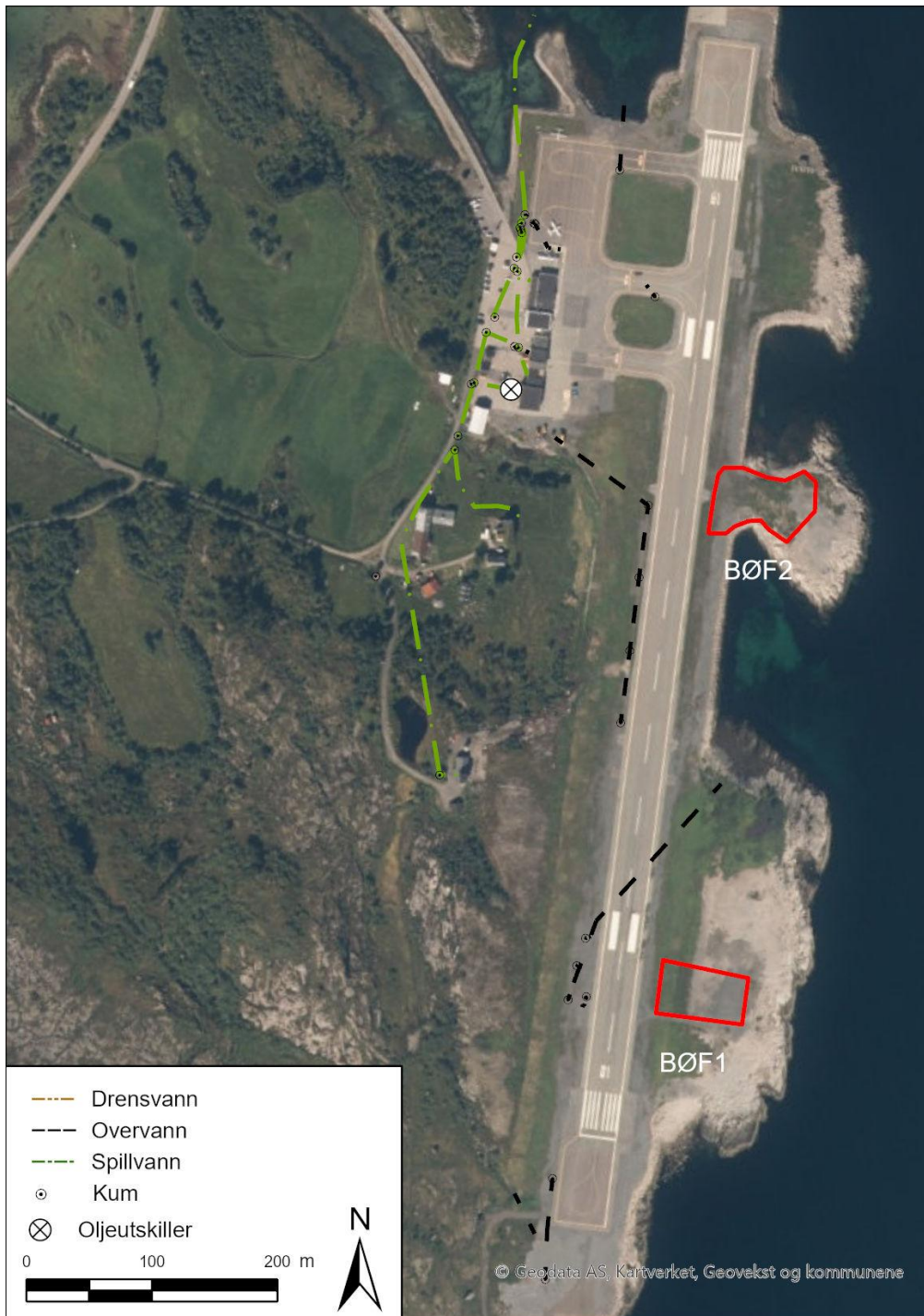
Figur 2-5: VA-ledninger på Svolvær lufthavn. Det er ingen VA-ledninger på eller nær brannøvingsfeltene (områder for undersøkelsene utført i 2024 er vist med rødt omriss). Grunnlag for ledningsnett er mottatt fra Avinor.
