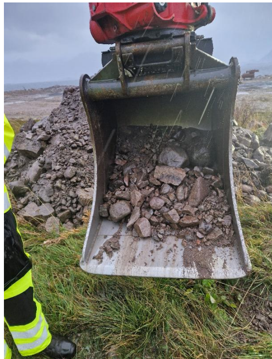
Figur 5-2: BØF1-SJ11. Fyllmasser bestående av stein/blokk og sand.
