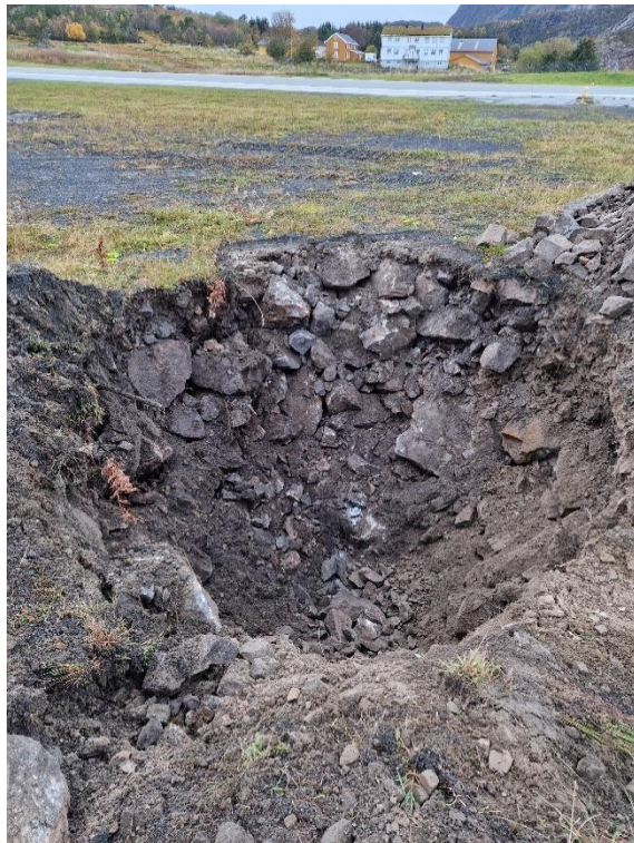
Figur 5-4: BØF2-SJ03. Sprengsteinsfylling i punktene nærmest rullebanen.
