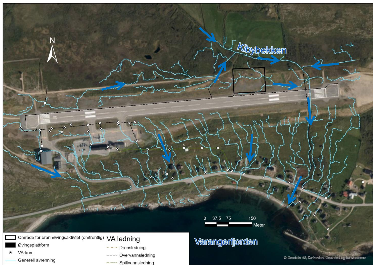
Figur 2-5. Kart over teoretiske vannveier i og rundt lufthavnsområdet, generert i Scalgo Live [14]. De lyseblå linjene viser hvilken vei vann teoretisk vil renne, basert på en terenganalyse. Piler indikerer generell retning for avrenning.
