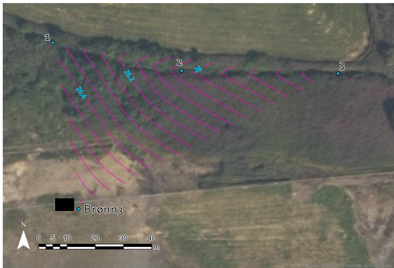
Figur 5-9. Strømningskart (kotenivå) for grunnvann, basert på innmålinger i brønn og bekk. Kotekartet indikerer at strømningsretningen for grunnvann på BØF er mot nordøst. Innmålingspunktene i bekken er vist som «1», «2» og «3». Øvingsplattformen er markert som sort firkant.
