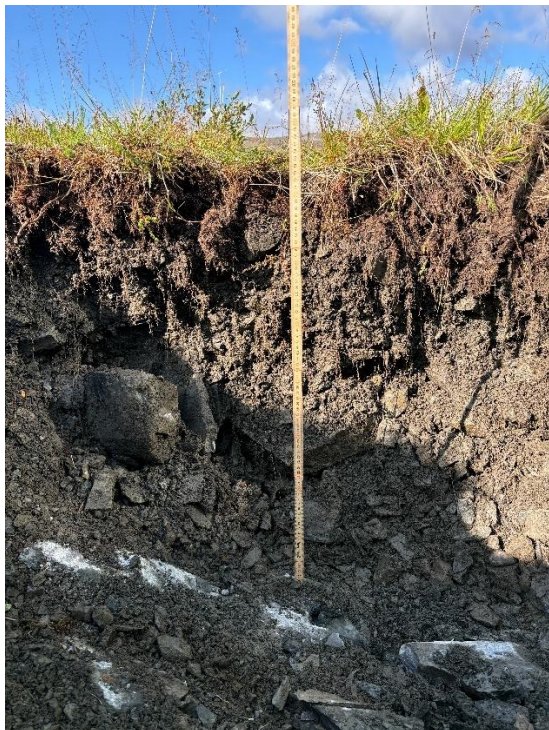
Figur 5-1: SJ25, org. rik jord over omrørte masser og berg.
