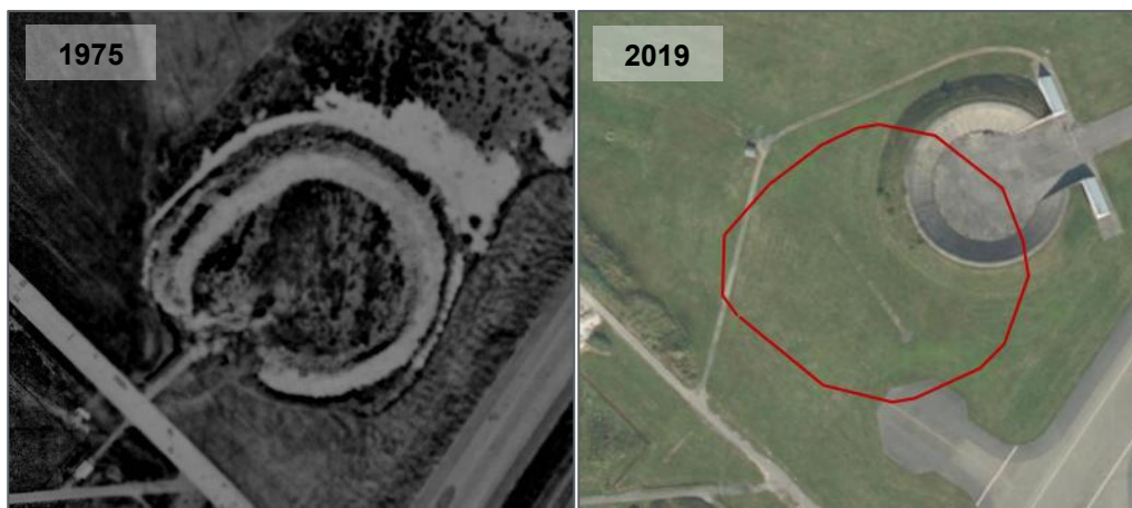
Figur 2-2: Historiske flyfoto som viser jordvullen rundt gammelt brannøvingfelt (BØF3) (1975), samt etter planering av jordvullen og etablering av rusegrop (2019). Omriss av jordvullen er tegnet inn med rødt i flyfoto fra 2019 (flyfoto fra kart.finn.no).
