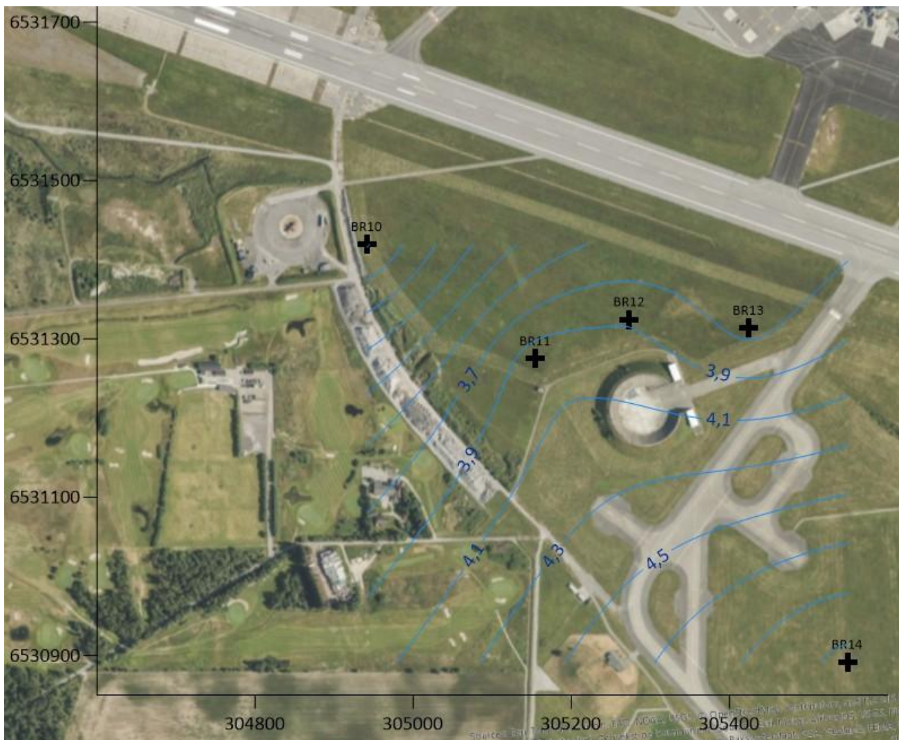
Figur 5-8: Interpolerte grunnvannskoter basert på manuelle målinger i grunnvannsbrønner ved område for tidligere brannøving (BØF3) den 18. september 2025. Generell strømningsretning er mot Regebekken og det aktive brannøvingsfeltet (BØF1) nordvest for BØF3.
