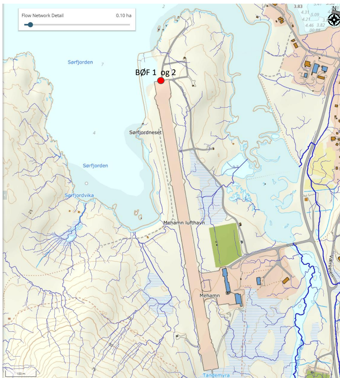
Figur 4 Avrenning fra lufthavn mot sjø og elv (Scalgo Live, 2021). BØF (rød).
