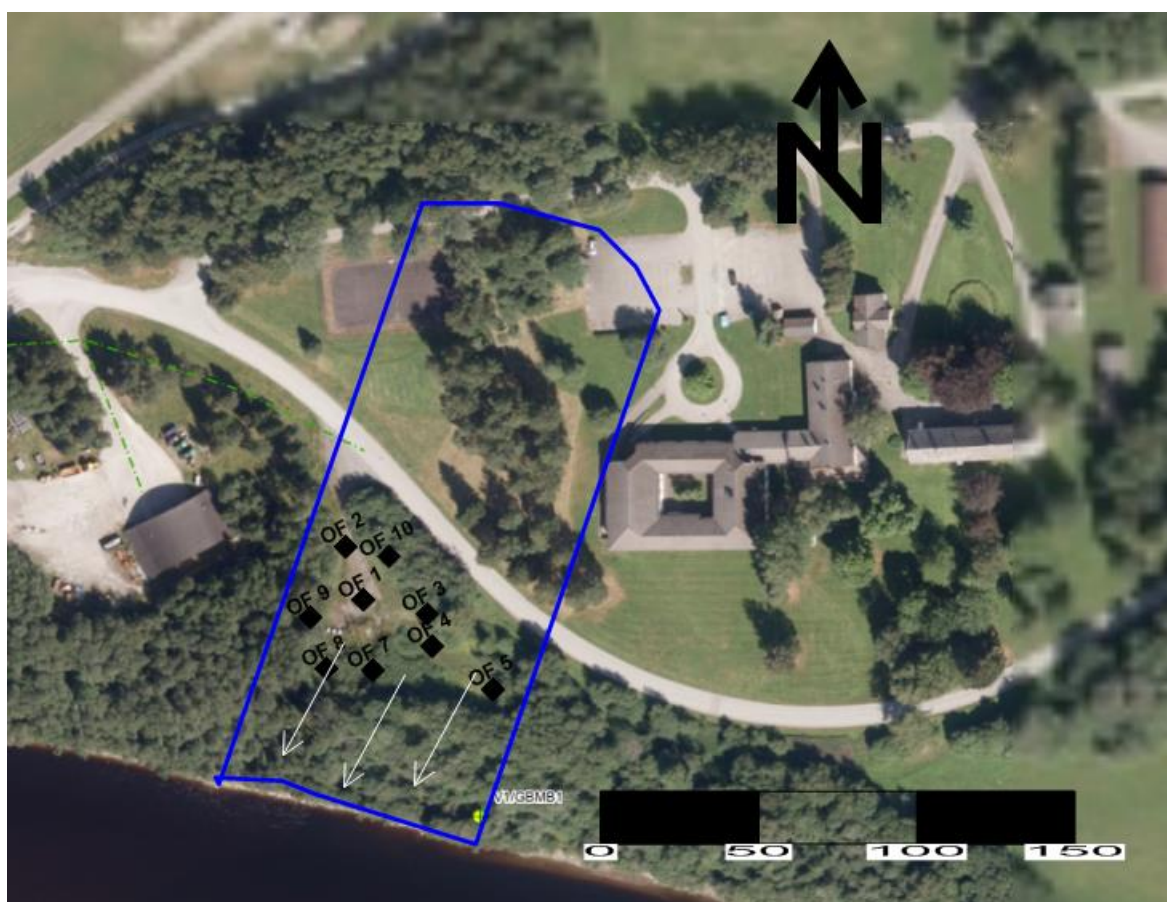
Figur 7-3. Viser antatt nedbørsfelt til BØF-1 og området rundt med blått polygon. Jordprøvepunkter er markert med sorte punkter. Antatt strømningsretning for grunnvann vist med hvite piler. Sirkel markert med kryss er brønn. Venstre side av sirkel har fargekode for PFOS-klasse, mens høyre side av sirkel har fargekode for PFAS-klasse. Klassifiseringen er basert på gjennomsnittsverdier for målingene som er gjort i punktet. Det er analysert flere prøver for PFOS enn av PFAS.
