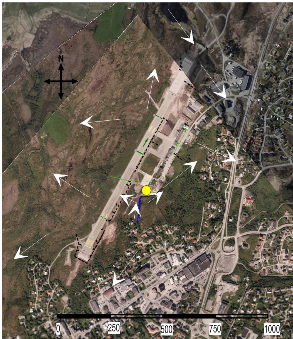
Figur 7-2. Overordnede dreneringsretninger ved Leknes lufthavn vist med hvite piler. Grøfter og overvannsledninger vises med sort stiplet linje. BØF er vist med gul sirkel. Grønne piler viser retning avrenning fra rullebanen. Blå linjer er bekker. Grønn stiplet linje er spillvannsledning.
