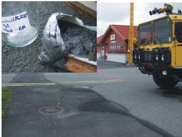
Prøvetaking ved overvannskum
