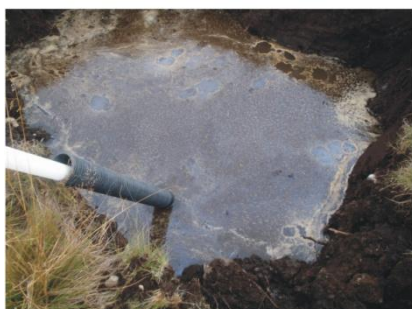
Figur 4. Bilder av varierende forhold i sjaktene. I sjakt S8 er det oljefilm på vannet, bildet viser nedsetting av brønn.
