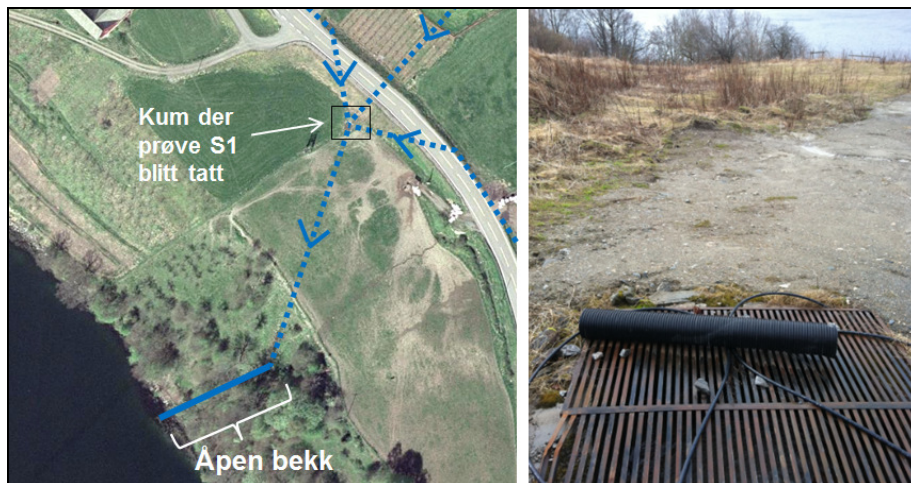
Figur 15: Flybilde med skisse samt bilde på kum vest om tidligere strekningen av E39 (der S1 blitt tatt).
