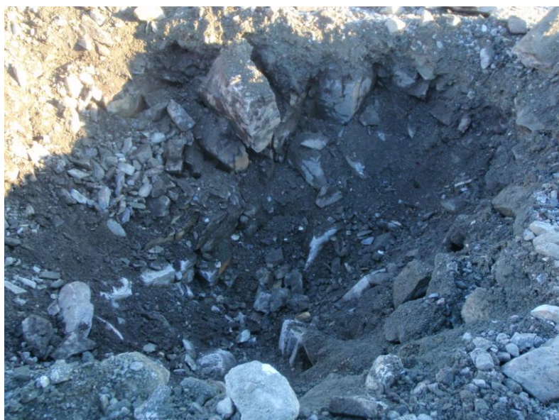
Figur 3. Under det nye brannøvingsfeltet er det grovkornede løsmasser av sprengstein.
