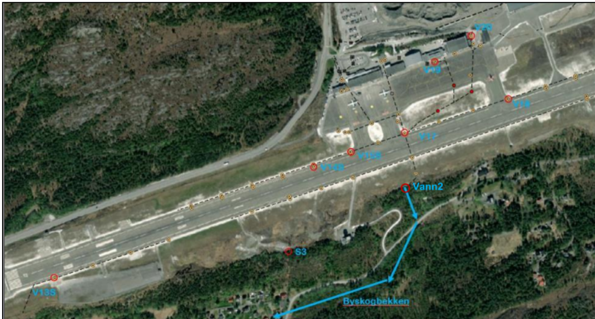
Figur 3: Eksisterende VA-system ved lufthavnen. BØFB ligger nordvest for vannprøvepunkt S3. Prøvepunkter for vann og sedimentprøver er merket i kartet. I tillegg er Vann2 (utslippspunkt fra overvannssystem) vist. Kilde: Tiltaksplan 2023 [2].
