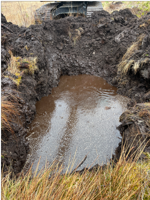
Figur 8: Prøvepunkt SJ183. Det ble ikke gravd til fjell i dette punktet pga. at grøfta ble fylt av vann ved graving under 2 m.
