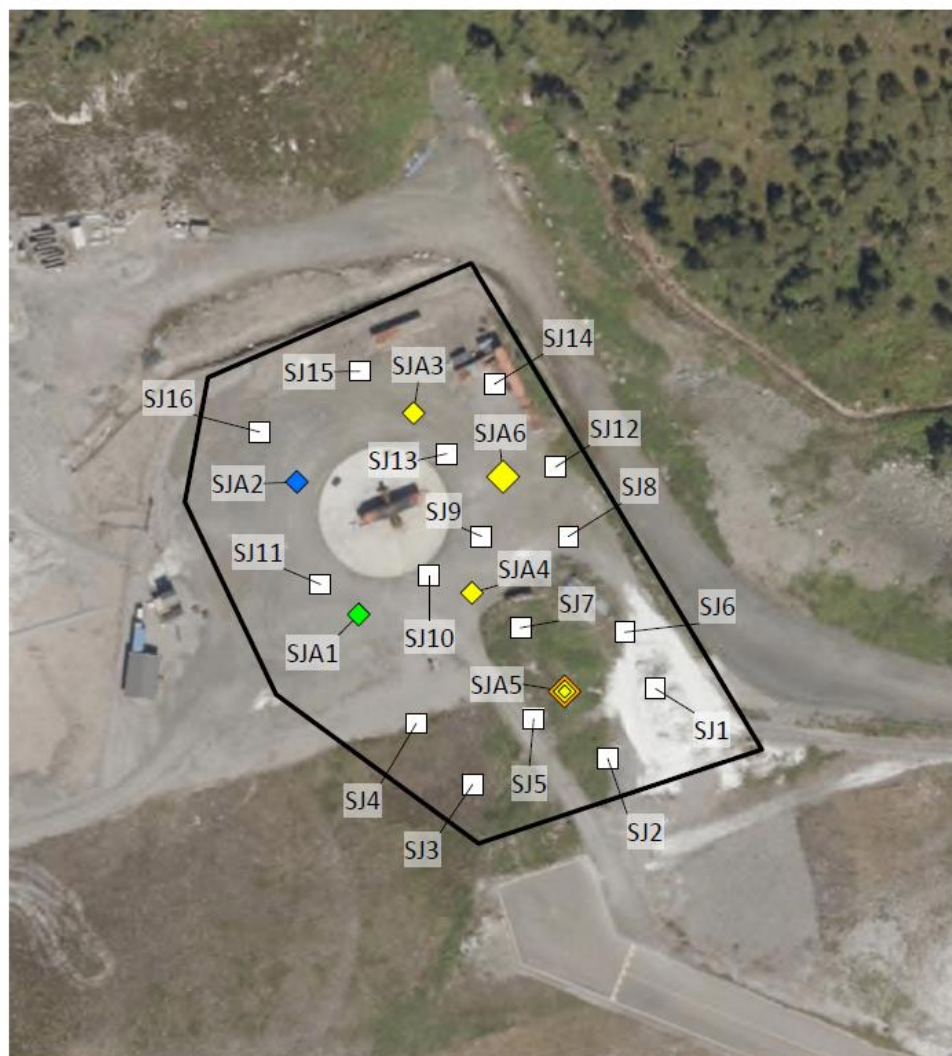
Figur 3-1: Prøvepunkter for supplerende undersøkelser i jord ved aktivt brannøvingsfelt (BØF A) (hvite kvadrat). Tidligere prøvetatte punkter er fargekodet etter påviste konsentrasjoner i henhold til fargeskala i tegnforklaringen.
