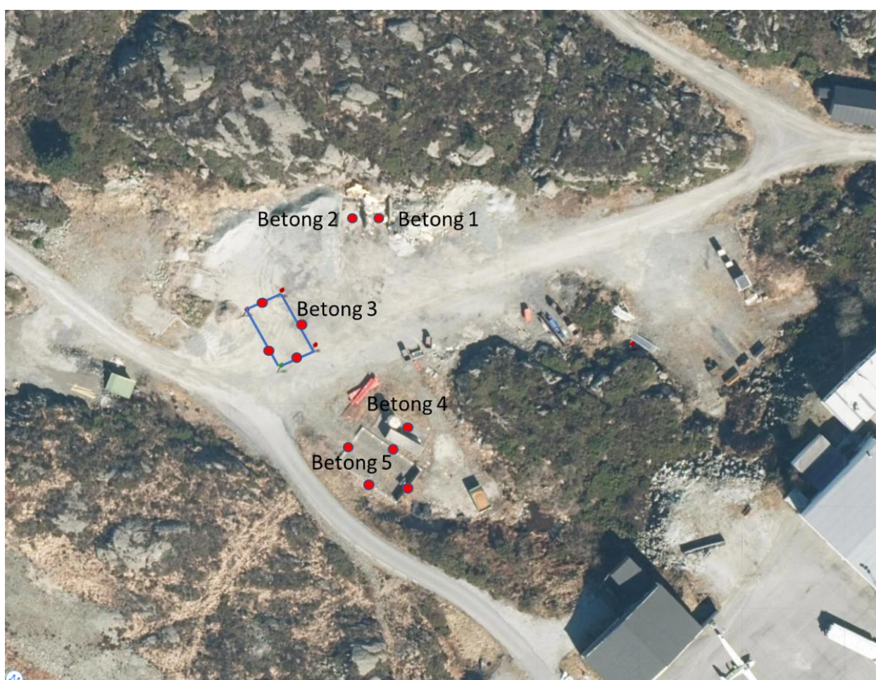
Figur 7: Flyfoto av det tidligere brannøvningsfeltet (BØFB) med markering av betongkonstruksjoner som må fjernes før etablering av grøfter, brønner og utgraving. Betong 1, 2 og 4 er plater på mark, mens betong 3 og 5 er ringmur. Betong 3 er ringmuren for det tidligere brannøvningsbassenget.
