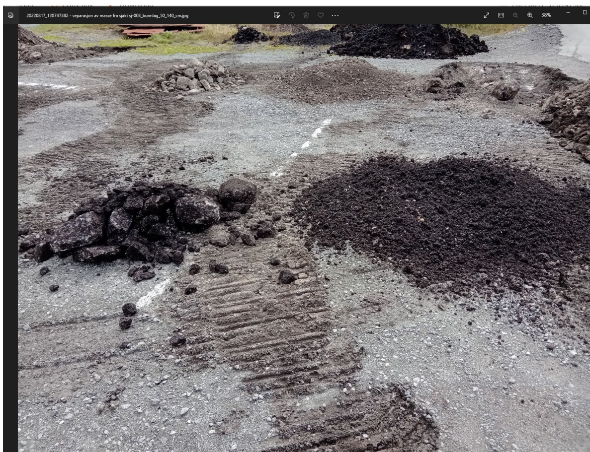
Figur 32. Eksempler på sikting av masser på BØFB ved Haugesund lufthavn 16.08.2022. De fremst to haugene er fra sjakt 3 fra 50 – 140 cm dyp. De to bakenforliggende haugene (grå) er fra 0-50 cm dyp. De dypere liggende massene består delvis av stedege organisk rike jord/ myrmasser. Den grove fraksjonen er noen avrundet hvilket tyder på at det er naturlige masser fra stedet. De øvre massene (0-50 cm) er tilkjørte masser, grus og sprengstein.
