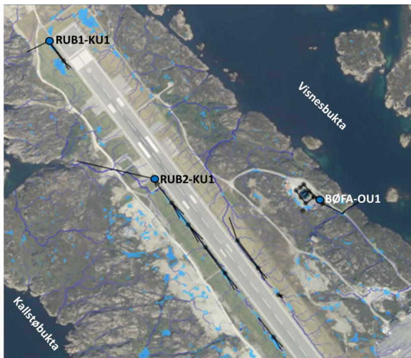
Figur 13. Oversikt over overvannsnettets som går langs rullebanen på NV-delen av Haugesund lufthavn. Vannprøvene ble tatt i overvannskummer med sandfang (RUB1 og RUB2 – blå rundinger) med utløp mot Kallstøbukta, samt av oljeutskilleren (BØFA-OU1) med overløp ut i Visnesbukta den 10-12 november 2021.
