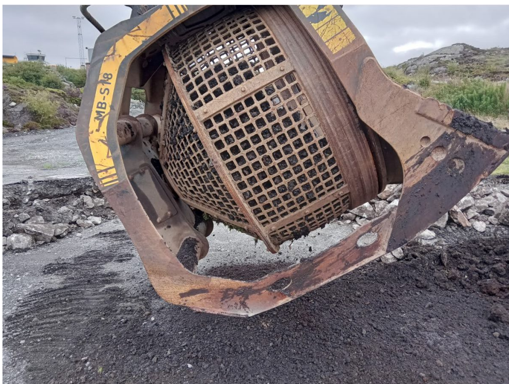
Figur 24. Siktetrommel montert på graver fra Vasbakk & Stol AS den 16.08.2022 for sikting av masser fra BØFB på Haugesund lufthavn.
