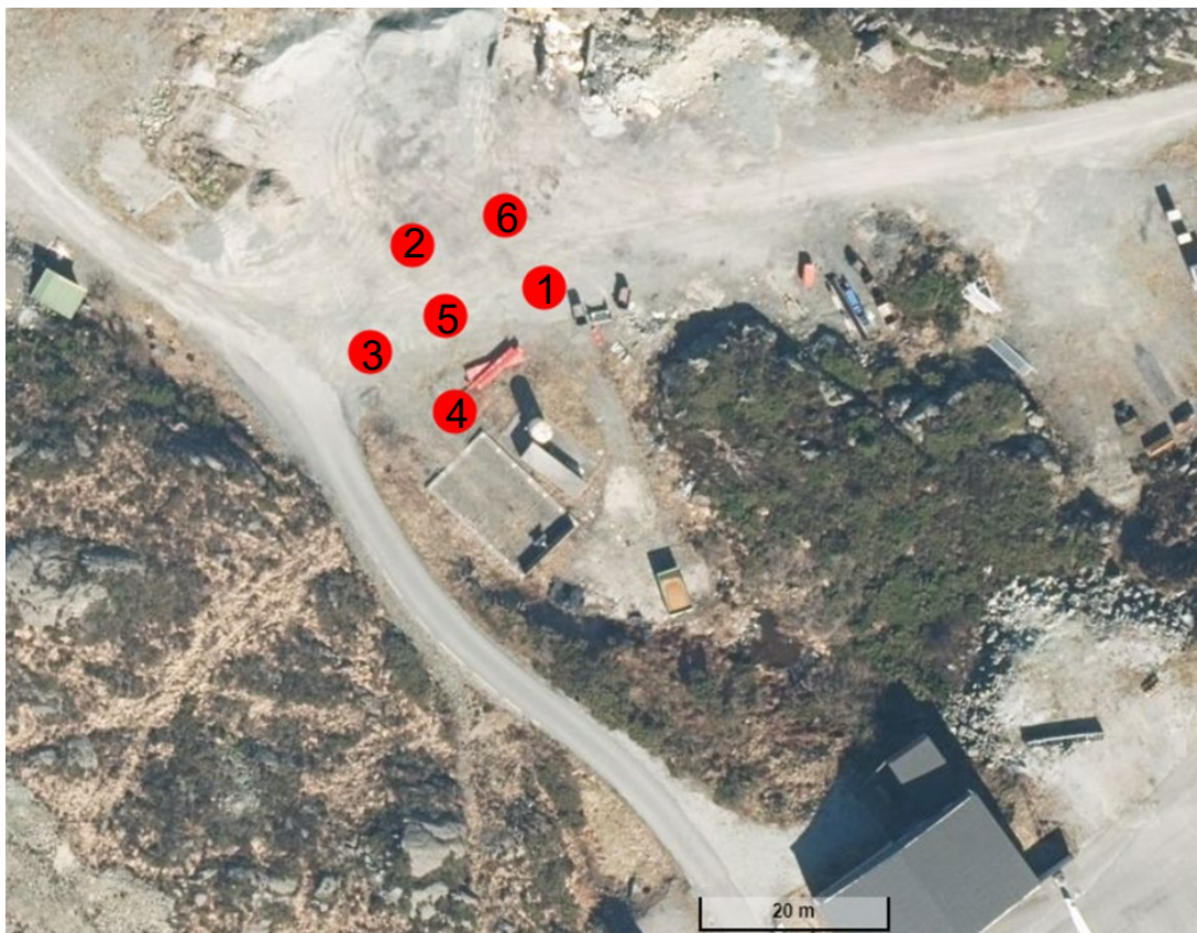
Figur 25. Punkter for utgraving av masser (sjakting) på BØFB på Haugesund lufthavn 16.08.22 for fraksjonering ved bruk av siktetrommel (Figur 24).
