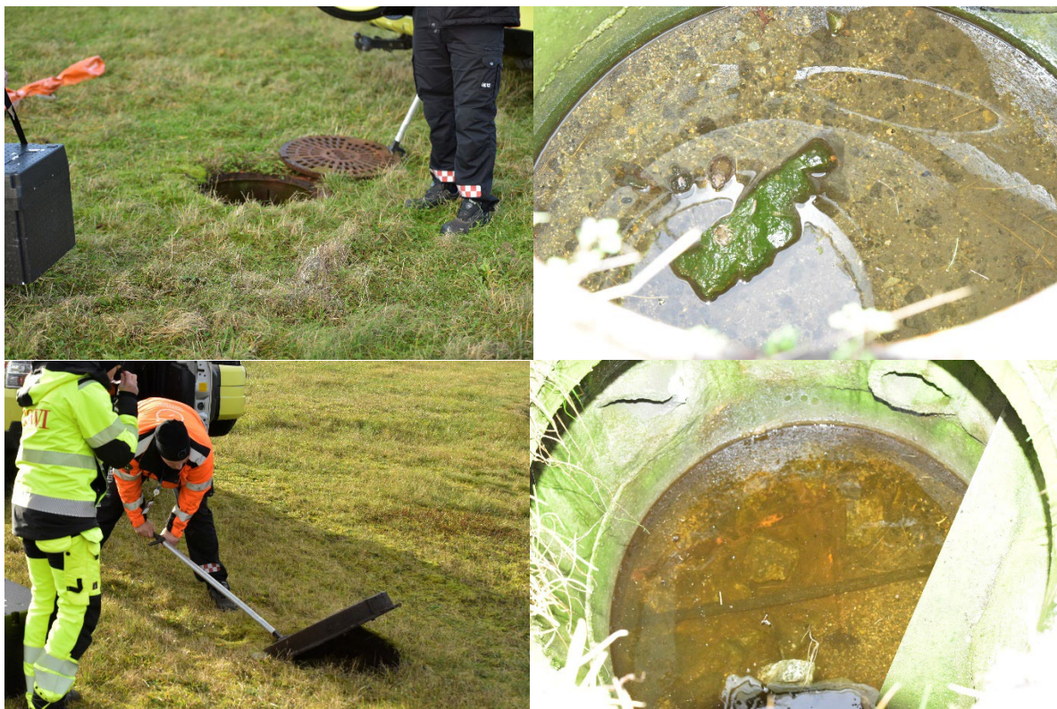
Figur 15. Bildene oppe til venstre og høyre viser åpning av kum RUB1 og nede i kammeret på prøvetakings-tidspunktet, mens bildene nede til venstre og høyre viser åpning av kum RUB2 og nede i kammeret før prøvetaking (Foto: Tom Tellefsen).
