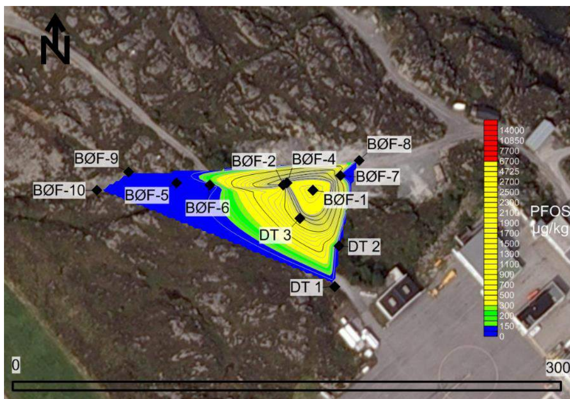
Figur 7-4. Viser interpolert PFOS-konsentrasjon i jord på og rundt BØF B for alle prøver fra 0-180 cm. Interpoleringen er gjort i programvaren Surfer, og interpoleringsmetoden som er brukt er "natural neighbor".
