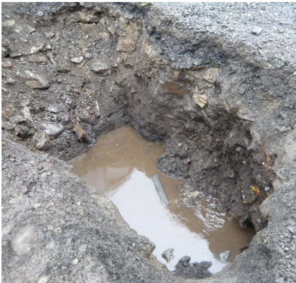
Figur 5: Oljefilm på vann i sjakt DT 3 (venstre) og oljeklissete jordmasser fra sjakt DT 3 med jernskrot, trevirke, plast, byggavfall osv.
