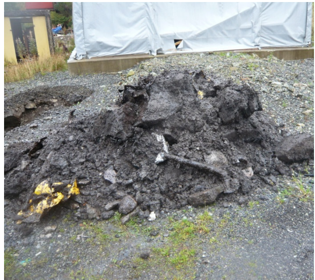
Figur 5: Oljefilm på vann i sjakt DT 3 (venstre) og oljeklissete jordmasser fra sjakt DT 3 med jernskrot, trevirke, plast, byggavfall osv.
