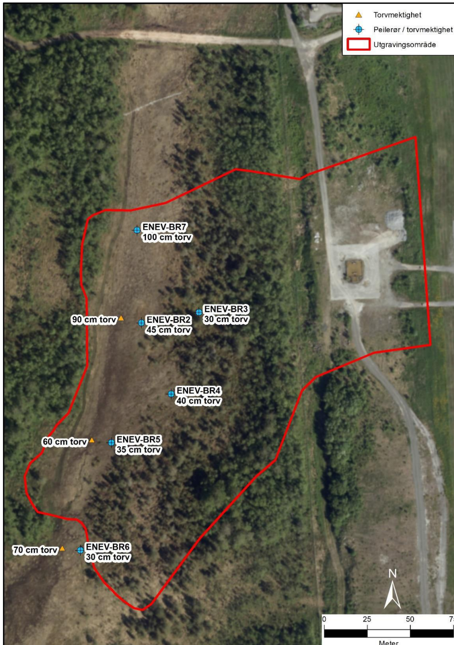
Figur 9. Flyfoto med innlagt plassering av peilerør (blå punkter) for vannstand i det forurensede myrarealet innenfor tiltaksområdet, før sanering. Tiltaksområdet ligger innenfor den røde heltrukne linjen. Det nedlagte brannøvingsfeltet ligger til høyre for midten av bildet.
