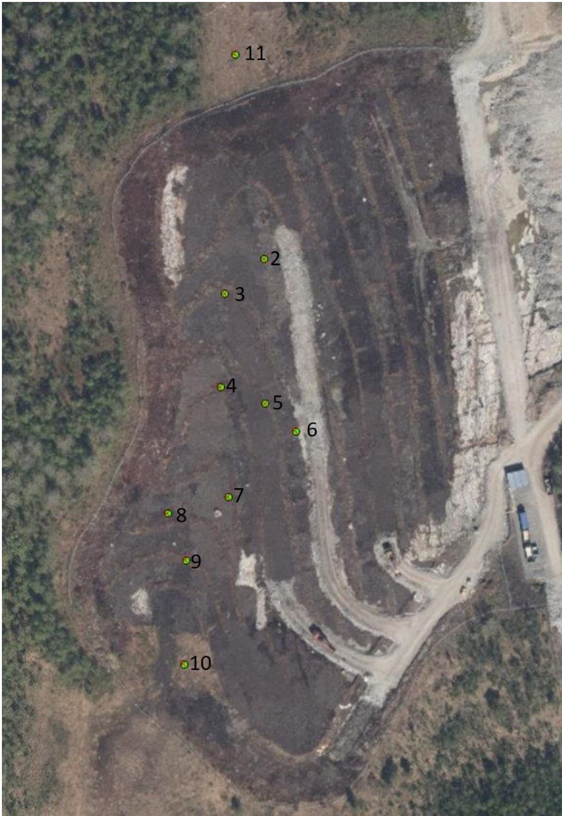
Figur 8. Flyfoto av situasjon etter første fase av restaurering av det tidligere PFAS forurensede myrarealet nedstrøms brannøvingsfeltet sommeren 2021. Punktene hvor arts-, og naturtyperegistrering ble utført av Ecofact den 24 august 2022 er markert med grønne sirkler og tallfestet. Plasseringen av punktene er de samme som forundersøkelsen før sanering av forurensningen. Punkt 10 og 11 er referansepunkter på intakte myrpartier.
