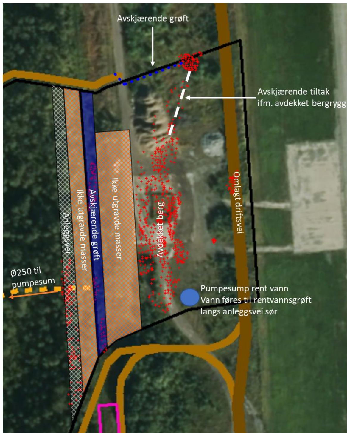
Figur 4: Avbøtende tiltak for i størst mulig grad avskjære rentvann fra områder under utgraving. 1) Avrenning inn i østlige utgravde deler av område 4/5 avskjæres naturlig av bergterskel NS sentralt i utgravingsområdet. Avskjæringen forsterkes i nordlig del og kontrolleres i hele sin lengde. Traubunn har fall mot sør i det utgravde området øst for bergterskel og vann føres mot pumpesump for rentvann. Rent vann føres til rentvannsgrøft langs anleggsvei sør for tiltaksområdet (utenfor kartbildet). 2) Avrenning inn i utgravingsområdet fra nord avskjæres med grøft og føre under opprinnelig driftsvei og slippes på terreng nord for anleggsveien langs nordsiden av tiltaksområdet.
