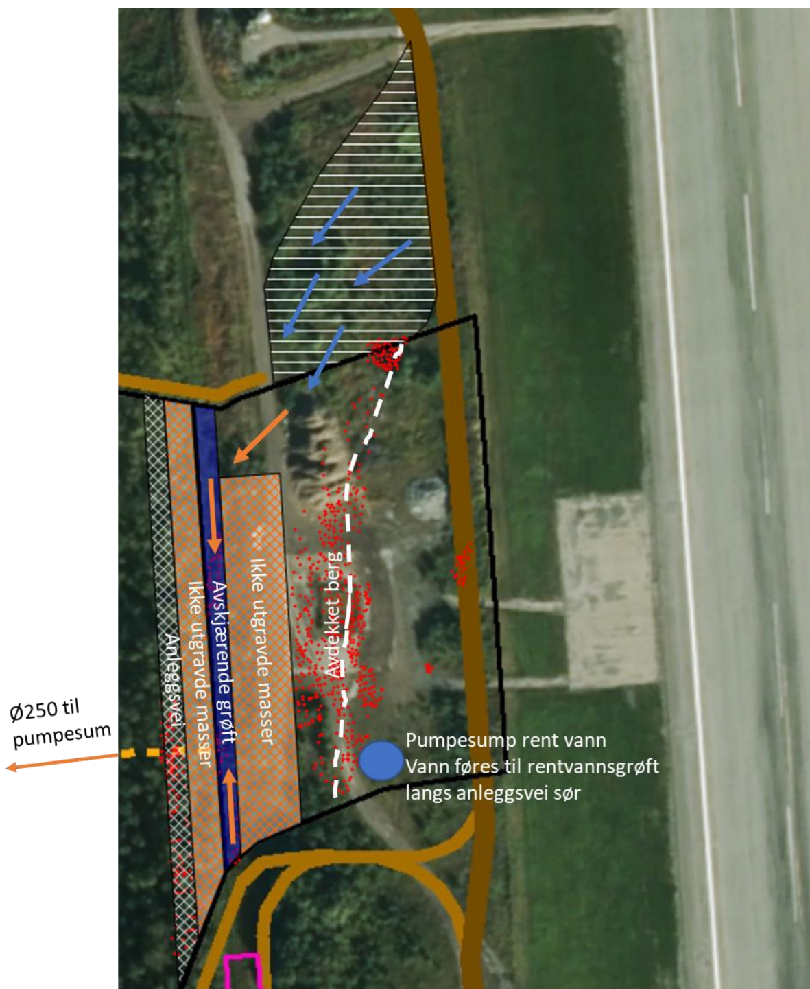
Figur 1: Avrenning inn i østlige utgravde deler av område 4/5 er oppgitt å naturlig avskjæres av bergterskel NS sentralt i utgravningsområdet (innmålt berg vist med røde prikker, ca. plassering terskel angitt med hvit stiptet linje). Vannet føres til pumpesump for rent vann og føres til rentvannsgrøft langs anleggsvei sør (utenfor kartbildet). Dette vannet er ikke tatt med i beregningen av teoretiske vannmengder til pumpesump for skittent vann. Basert på observasjoner i felt er det inkludert avrenning fra et deltefelt nord for utgravingsområdet (ca. 2500 m 2 ). Resterende areal inkludert i beregningene strekker seg fra bergterskel i øst t.o.m. anleggsvei i vest (ca. 6600 m 2 ).
