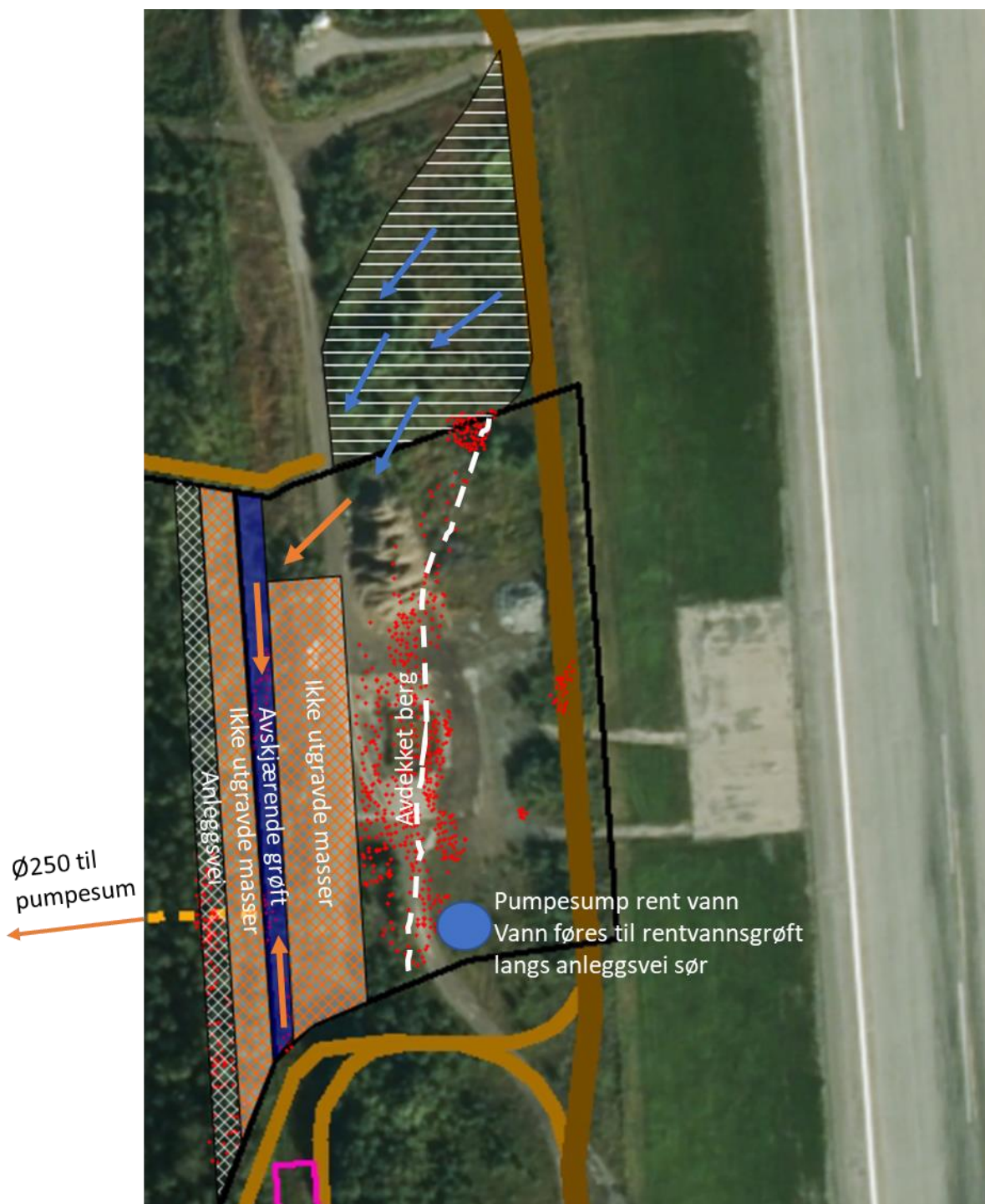
Figur 1: Avrenning inn i østlige utgravde deler av område 4/5 er oppgitt å naturlig avskjæres av bergterskel NS sentralt i utgravningsområdet (innmålt berg vist med røde prikker, ca. plassering terskel angitt med hvit stiplet linje). Vannet føres til pumpesump for rent vann og føres til rentvannsgrøft langs anleggsvei sør (utenfor kartbildet). Dette vannet er ikke tatt med i beregningen av teoretiske vannmengder til pumpesump for skittent vann. Basert på observasjoner i felt er det inkludert avrenning fra et deltefelt nord for utgravingsområdet (ca. 2500 m 2 ). Resterende areal inkludert i beregningene strekker seg fra bergterskel i øst t.o.m. anleggsvei i vest (ca. 6600 m 2 ).
