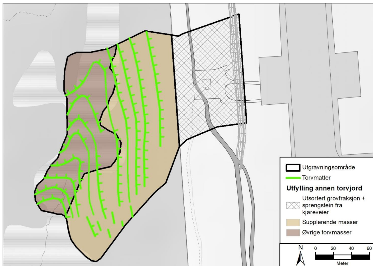
Figur 4: Utlegg av torvmatter og annen torvjord innenfor utgravningsområdet. Torvstriper er så langt praktisk mulig lagt normalt på forventet strømningsretning innenfor delområde 6 og 7, basert på innmålt trau og berg etter utgraving. Påtruffet berg under utgraving er vist i Figur 7.
