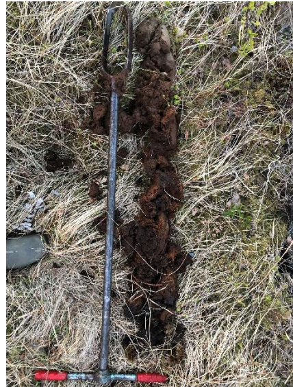
Figur 4: Prøvetaking av jord i Delområde E: OV-system sørvest ble utført i myrområde som mottar avrenning fra rullebanen. Massene i dette området var dominert av et øvre torv/organisk sjikt med varierende mektighet (20-110 cm) over underliggende mineraljord (grusig sand). Oversiktsbildet til venstre er tatt mot nord fra punktet ENEV MA 26 (se Figur 6 for plassering).
