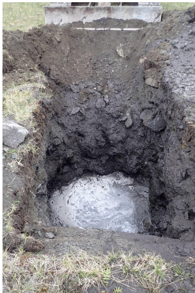
Figur 3: Bilder fra sjakt ENEV SJ 97 (venstre) og ENEV SJ 104 (høyre) som illustrerer noe av variasjonen i massetyper og vertikal fordeling av disse innenfor de undersøkte områdene av Delområde A: OV-system nord. Stedegen torv/organisk sjikt er påtruffet både i overflatesjikt (venstre) og i dypereliggende sjikt overfylt med fyllmasser (høyre).
