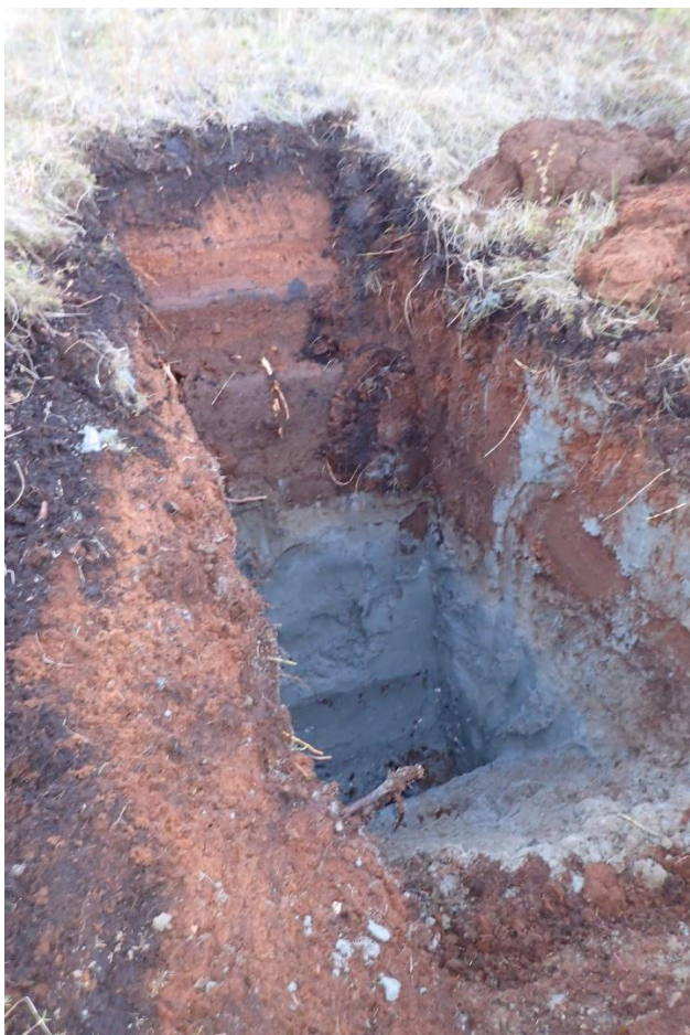
Figur 3: Bilder fra sjakt ENEV SJ 97 (venstre) og ENEV SJ 104 (høyre) som illustrerer noe av variasjonen i massetyper og vertikal fordeling av disse innenfor de undersøkte områdene av Delområde A: OV-system nord. Stedegen torv/organisk sjikt er påtruffet både i overflatesjikt (venstre) og i dypereliggende sjikt overfylt med fyllmasser (høyre).
