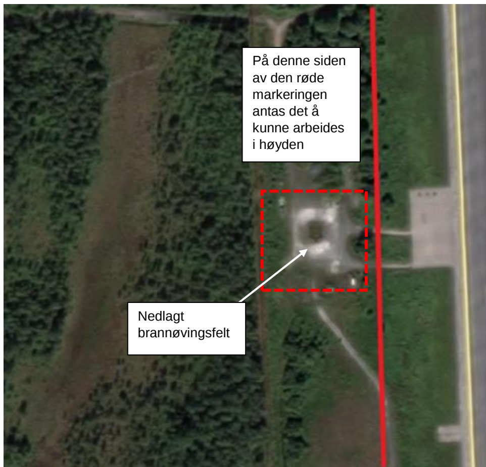
Figur 9: Område hvor det kan jobbes uten høydebegrensing for de aktuelle anleggsmaskinene.
