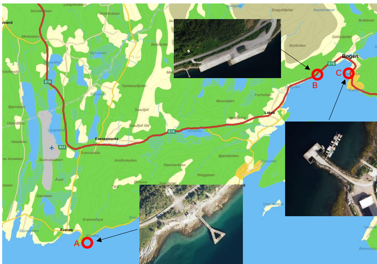
Figur 8: Alternative kaier som kan brukes til utskipping av de forurensede massene til deponi. Kaiene A og B tilhører Forsvaret og kai C er Bogen industrikai. Uttransport av masser fra kai C er lagt til grunn i kalkylene.
