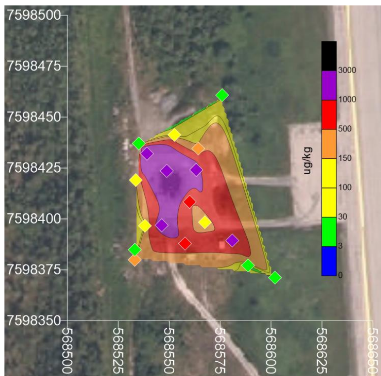
Figur 4: Interpolert konsentrasjonsfordeling av PFOS i fyllmasser på brannøvingsfeltet.
