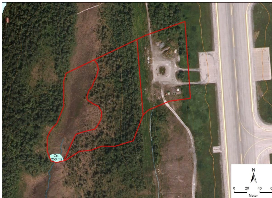
Figur 12: Ortofoto som viser koter (ekvidistanse 1 m), og anslått oppstuvning av vann sør i utgravningsområdet.
