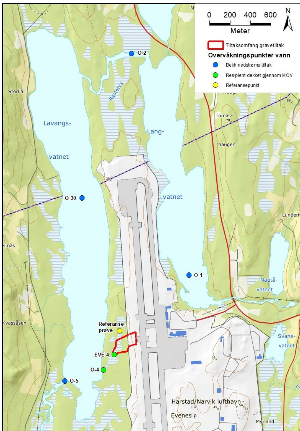
Figur 14: Foreslåtte overvåkningspunkter for vannprøver i resipient i bekk nedstrøms tiltaksområdet (grønne punkter) og overvåkningspunkter som inngår i Avinors miljøovervåkningsprogram (MOV) for lufthavnen (blå punkter).
