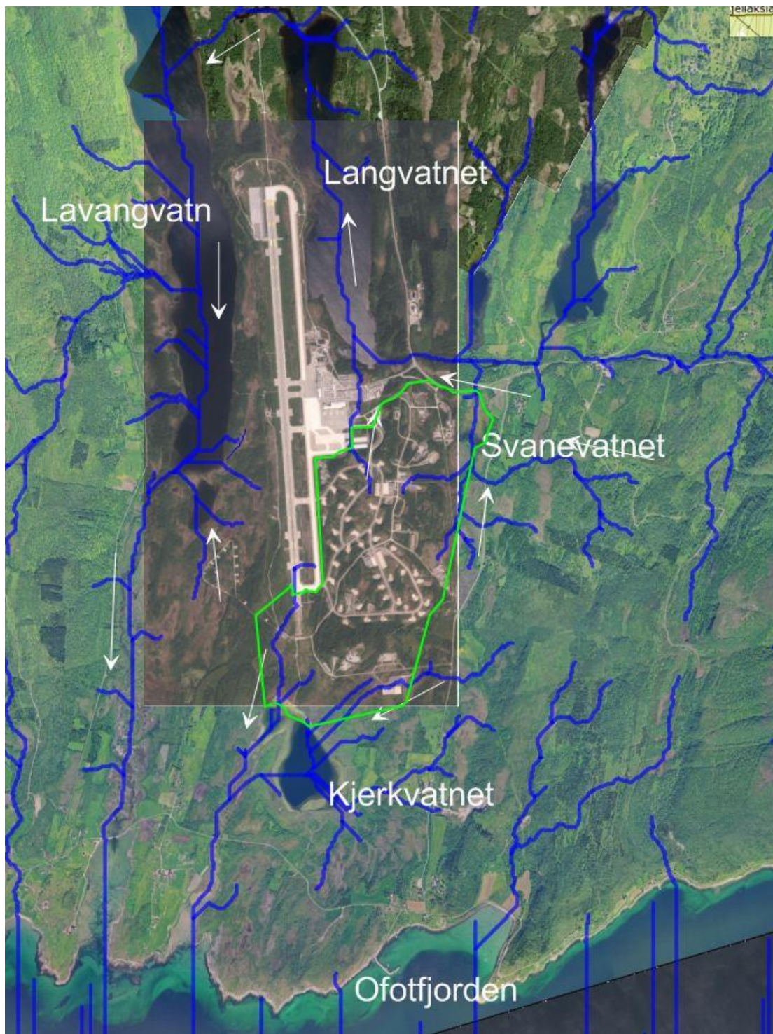
Figur 7-1. Dreneringskart for Evenes lufthavn og området rundt. De blå strekene er generert i programvaren Surfer ut fra en 10*10 meters terrengmodell og viser gradienten til terrenget. Hvite piler markerer strømningsvei. Figuren tar ikke hensyn til grøfter og lignende dreneringsveier. Militært område er markert med lysegrønt polygon.
