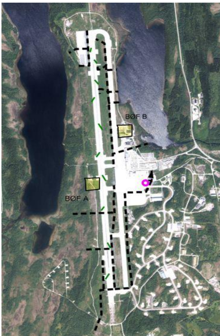
Figur 7-3. Grøfter og overvannsledninger på Evenes lufthavn vises med sort stiptet linje. Rosa sirkel er snødeponi. Grønne piler viser retning avrenning fra rullebanen. BØF A og BØF B vist med sorte firkanter.
