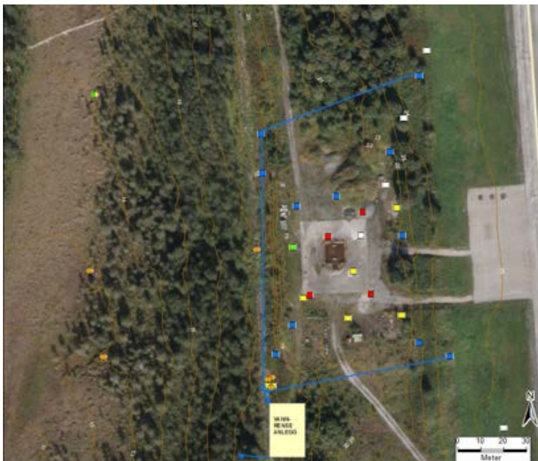
Figur 4-1: Skissert løsning A1 med samlegrøfter for vann til rensetrinn plassert nedstrøms.
