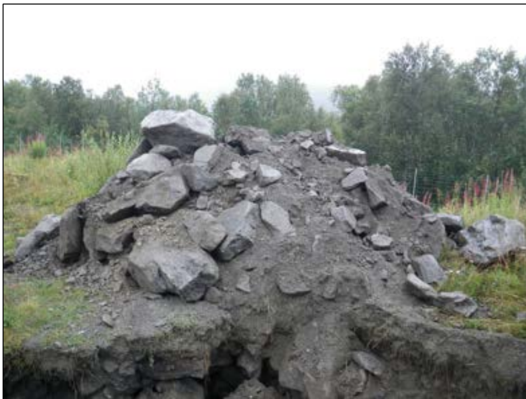
Figur 3-1: Utfylte masser over stedlig torv på BØF A, her vist som punktet E-BØF A 2-1 (Foto: Sweco Norge AS v/C.E. Nilsen).
