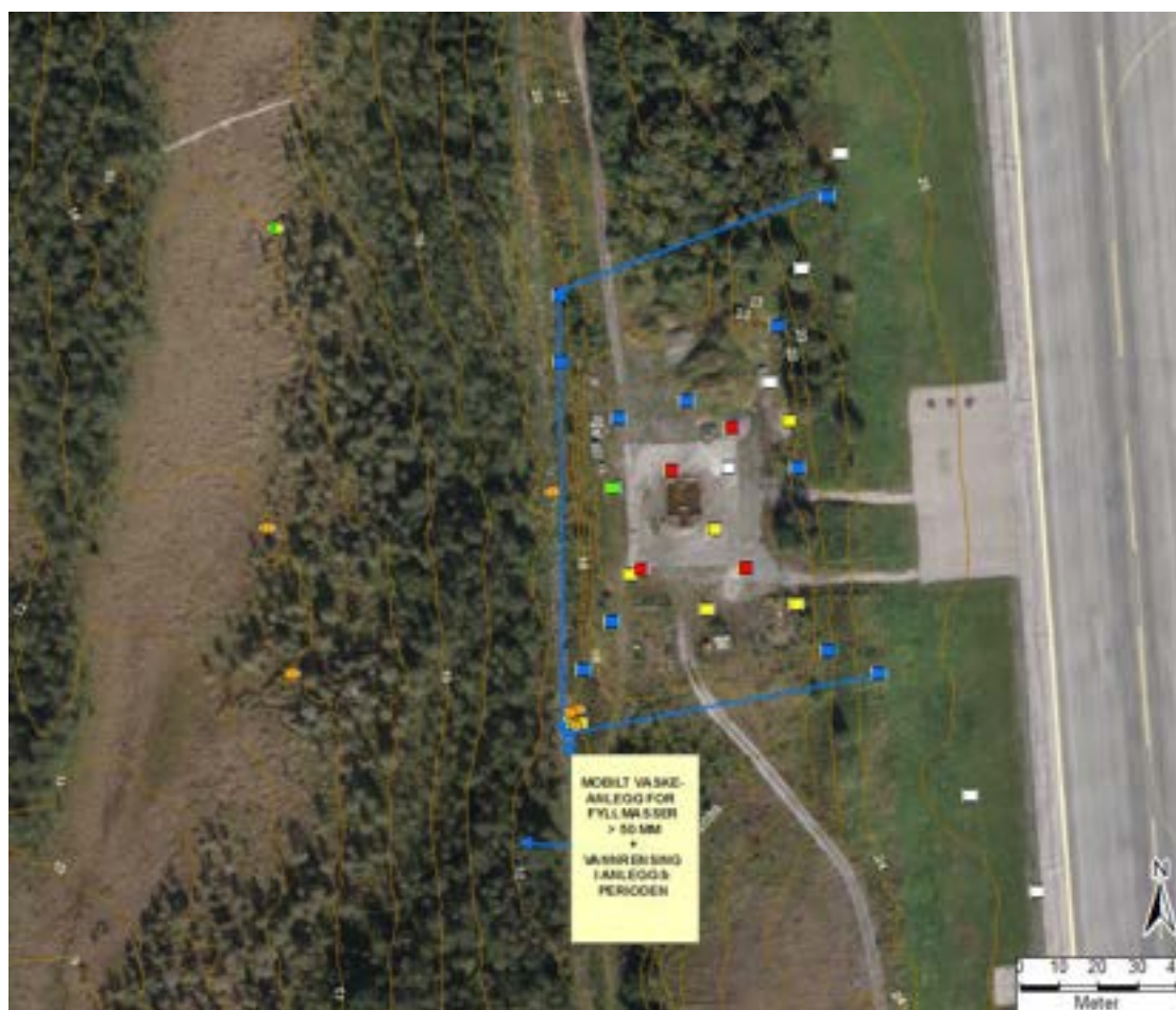
Figur 4-3: Prinsippskisse for bruk av mobilt vaskeanlegg for fyllmasser, sammen med oppsamling og rensing av vann i anleggsperioden (A1). Areal for utgraving som beskrevet for A2-1.
