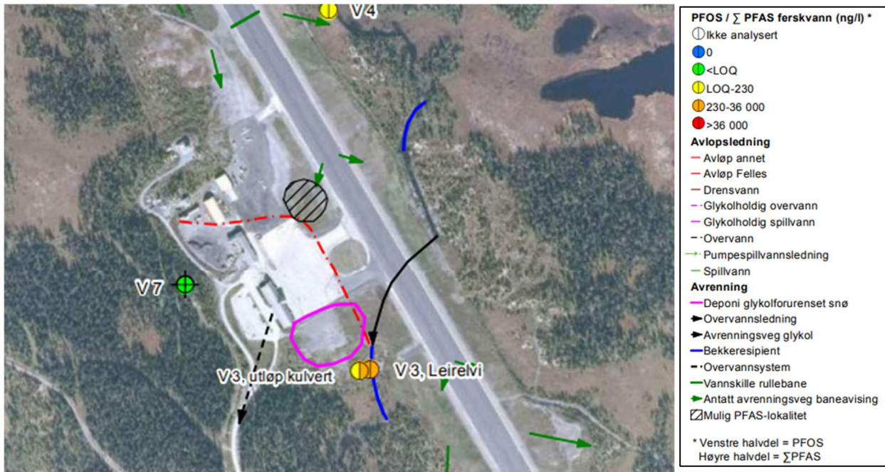
Figur 2 Plassering av snødeponi (rosa linje) og PFAS-lokalitet med vask- og innstilling av kanon (sort skraver). Rød stiple linje er i dag OV-ledning med avrenning til Leirelvi [7]
