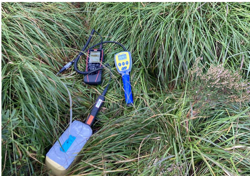
Figur 22 Foto av måleinstrumenter og fluksboks ved måling i felt.
