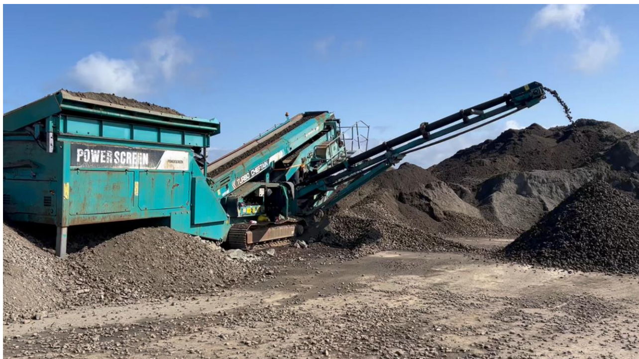
Figur 2-2: Det ble under gjennomføringen benyttet sikteverk for å separere masser i finere (<20 mm) og grovere fraksjoner (>20 mm).
