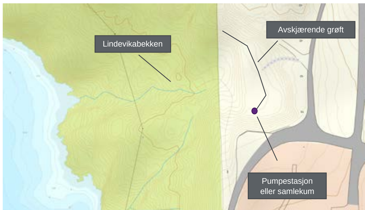
Figur 13: Avskjærende grøft for vannoppsamling.
