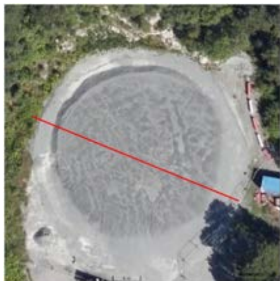
Figur 7-1: Prinsippskisse for utført tildekkingstiltak på sist nedlagte brannøvingsfelt (BØF1).
