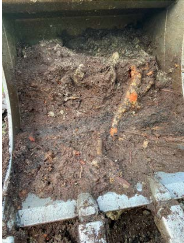
Figur 3-2: Massene på gammelt brannøvingsfelt (BØF2) er generelt karakterisert av grove fyllmasser i varierende mektighet (<0,5 – >4 m) over fjell eller underliggende torv (venstre bilde). Det ble påtruffet dypere liggende torv i tre av sjaktene. Denne var svært komprimert og middels omdannet, med noe fibrig struktur og synlige planterester (høyre bilde).
