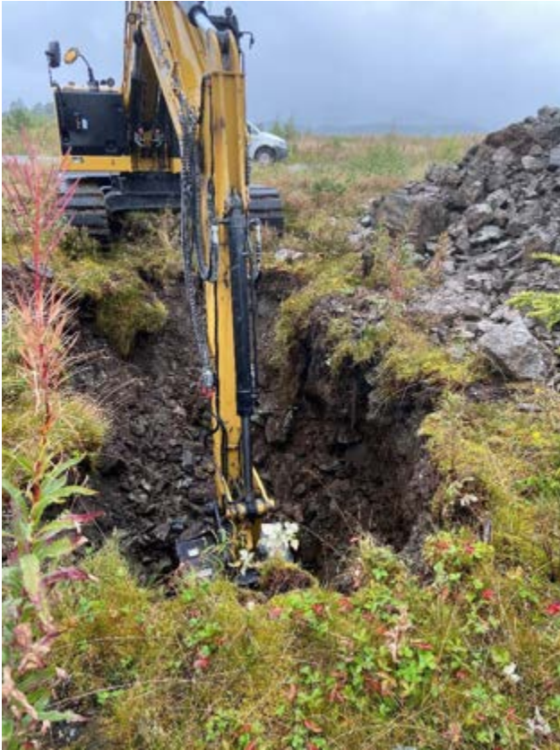
Figur 3-2: Massene på gammelt brannøvingsfelt (BØF2) er generelt karakterisert av grove fyllmasser i varierende mektighet (<0,5 – >4 m) over fjell eller underliggende torv (venstre bilde). Det ble påtruffet dypere liggende torv i tre av sjaktene. Denne var svært komprimert og middels omdannet, med noe fibrig struktur og synlige planterester (høyre bilde).
