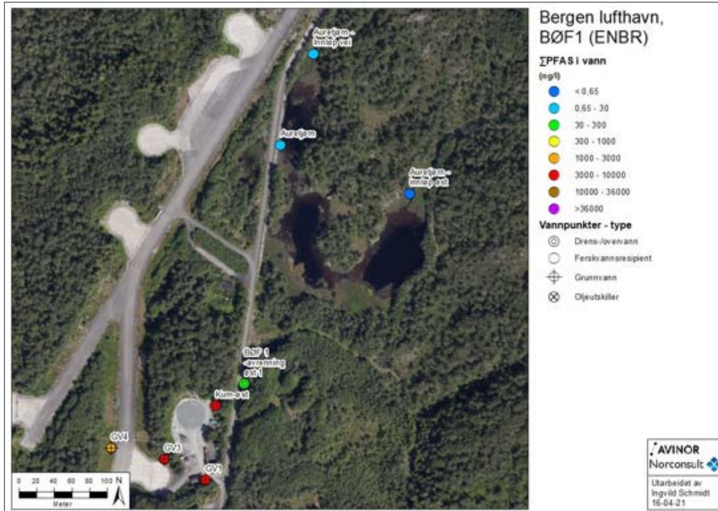
Figur 4-3: Analyseresultater fra prøvetaking av grunnvann ved brannøvingsfeltet (7. september 2020) og overflatevann (12. og 14. oktober 2020) ved sist nedlagte brannøvingsfelt (BØF1).
