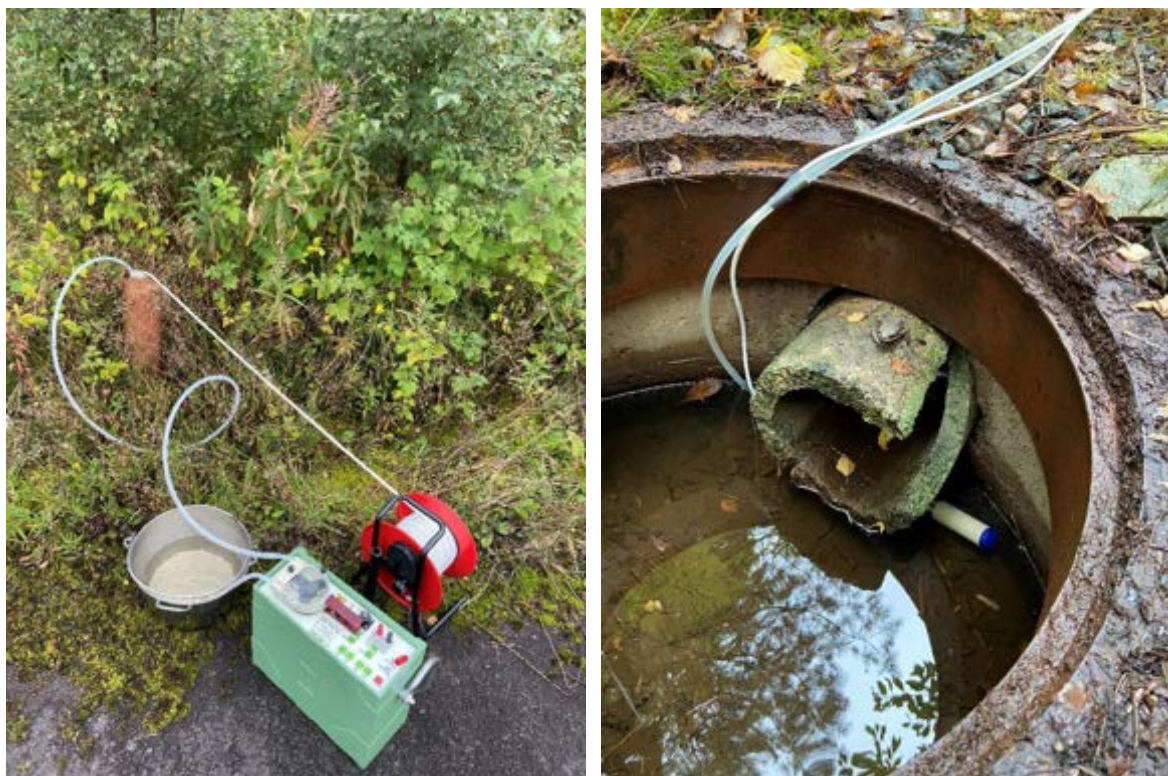
Figur 3-4: Prøvetaking av grunnvannsbrønn GV3 ved BØF1 (venstre bilde) og KUM-Ø (høyre bilde). KUM-Ø har åpen bunn og ble lenset tom i forkant av prøvetaking. Det var raskt tilsig av nytt vann til kummen etter lensing.
