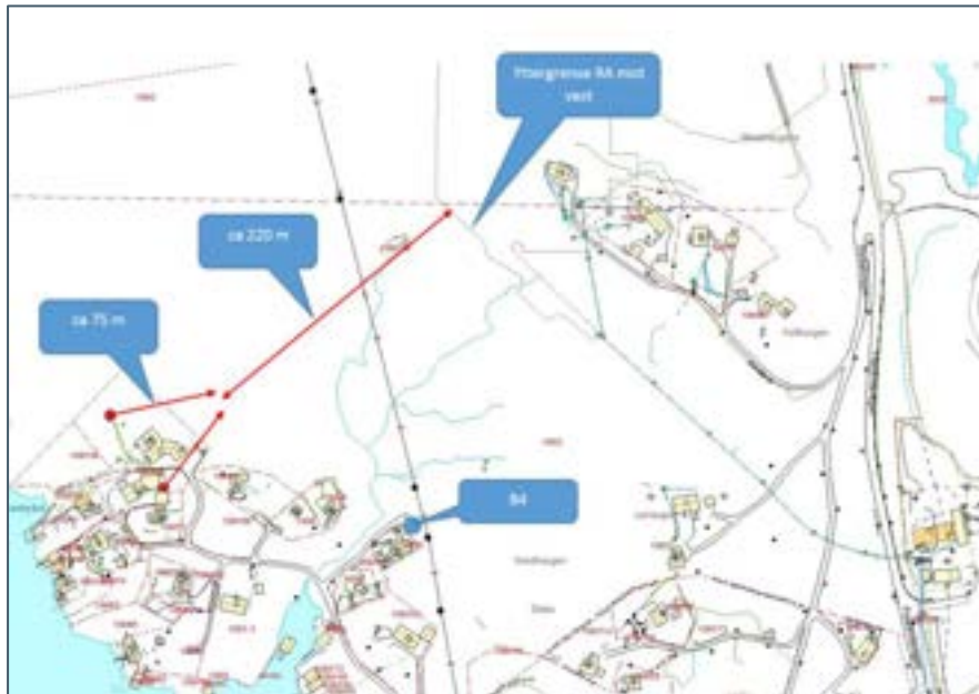
Figur 9: Oversikt over brønner og renseanlegg. Brønnen i Slettenvegen 93 og 101 er markert med røde prikker. Horizontal borretning og avstand er vist. Fra slutt punkt i borehullene til renseanleggets yttergrense er det ca. 220 m (COWI, 2016).
