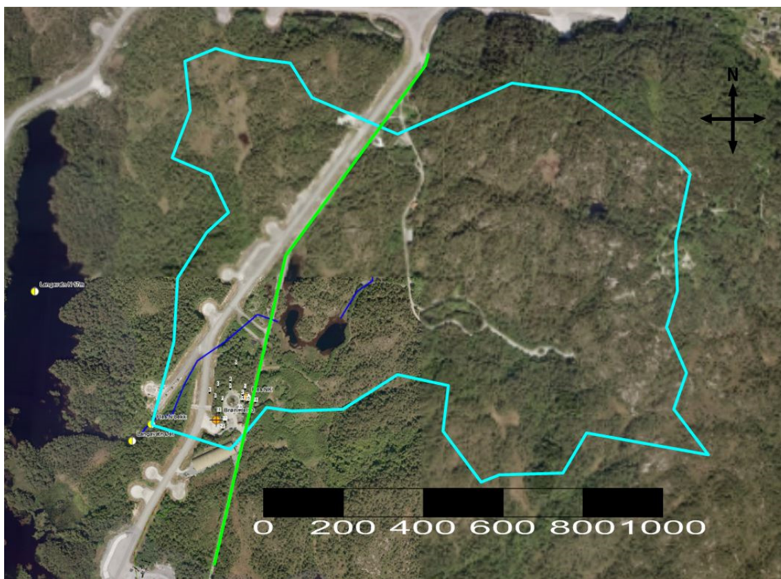
Figur 7-1. Viser nedbørsfeltet til aktiv BØF og området rundt med lyseblått polygon. Jordprøvepunkter er markert med sorte punkter sørøst i nedbørsfeltet. Bekken som drenerer myrområdet er vist med mørkeblått. Spillvannsledning er markert med grønn strek. Sirkel markert med kryss er brønner. Sirkel med loddrett strek er prøver av overflatevann. Venstre side av sirkel har fargekode for PFOS klasse. Høyre side av sirkel har fargekode for PFAS klasse. Klassifiseringen er basert på gjennomsnittsverdier for målingene som er gjort i punktet.
