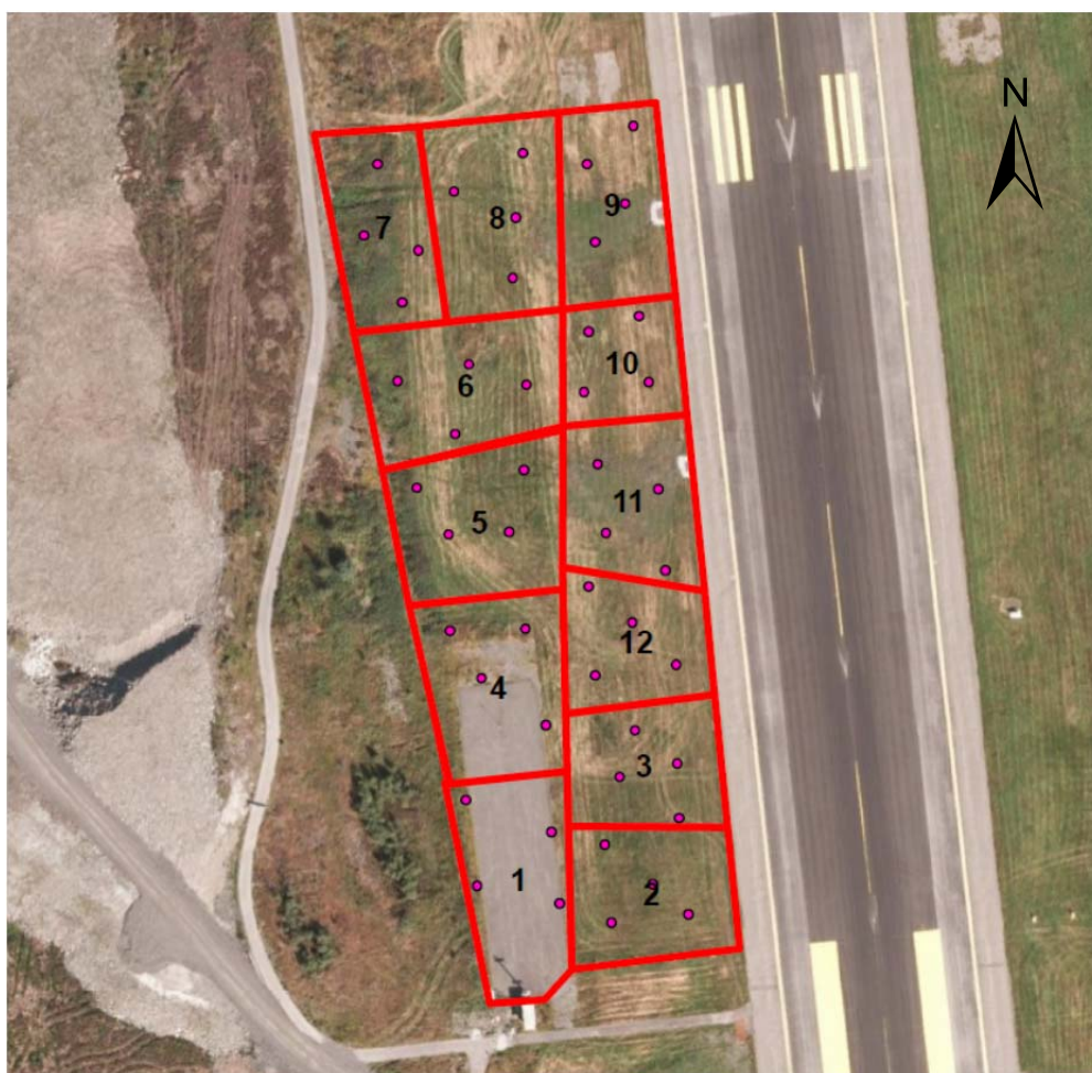
Figur 3. Prøvetakingsplan for glidebane 17. Rosa punkt er prøvepunkt. Felt avgrenset med rødt angir hvilke prøver som er blandet til én blandeprøve. Nummerering viser til prøvenr. Det vil si at blandeprøve Bprøve 1 er fra delområde merket 1 osv. Kartgrunnlag: geocache bilder.
