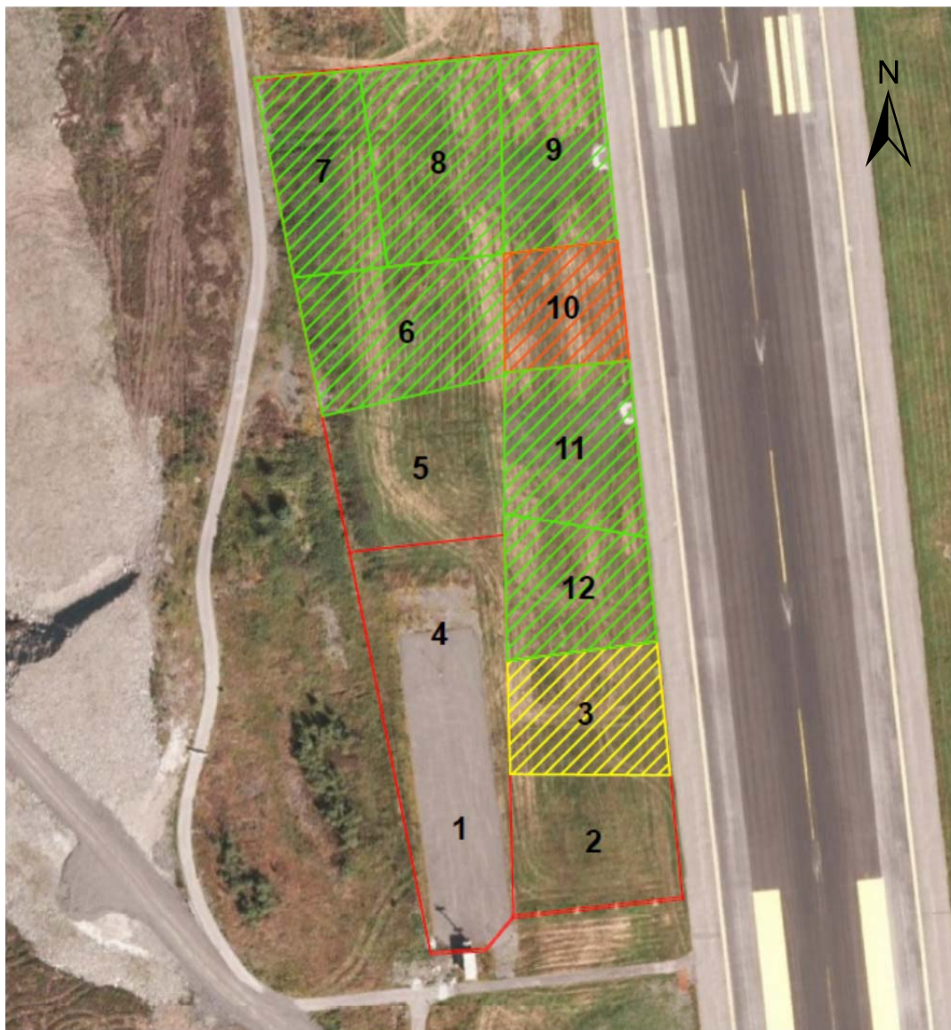
Figur 5. Forurensningssituasjonen i området for glidebane 17. Nummerering viser til blandeprøver (1 er Bprøve 1 osv.). Skraverte områder angir forurensing. Grønn skravur tilsvare tilstandsklasse 2, gul skravur tilsvare tilstandsklasse 3 og oransje skravur tilsvare tilstandsklasse 4. Område uten skravur er rene. Se nærmer forklaring i teksten. Kartgrunnlag: geocache bilder.
