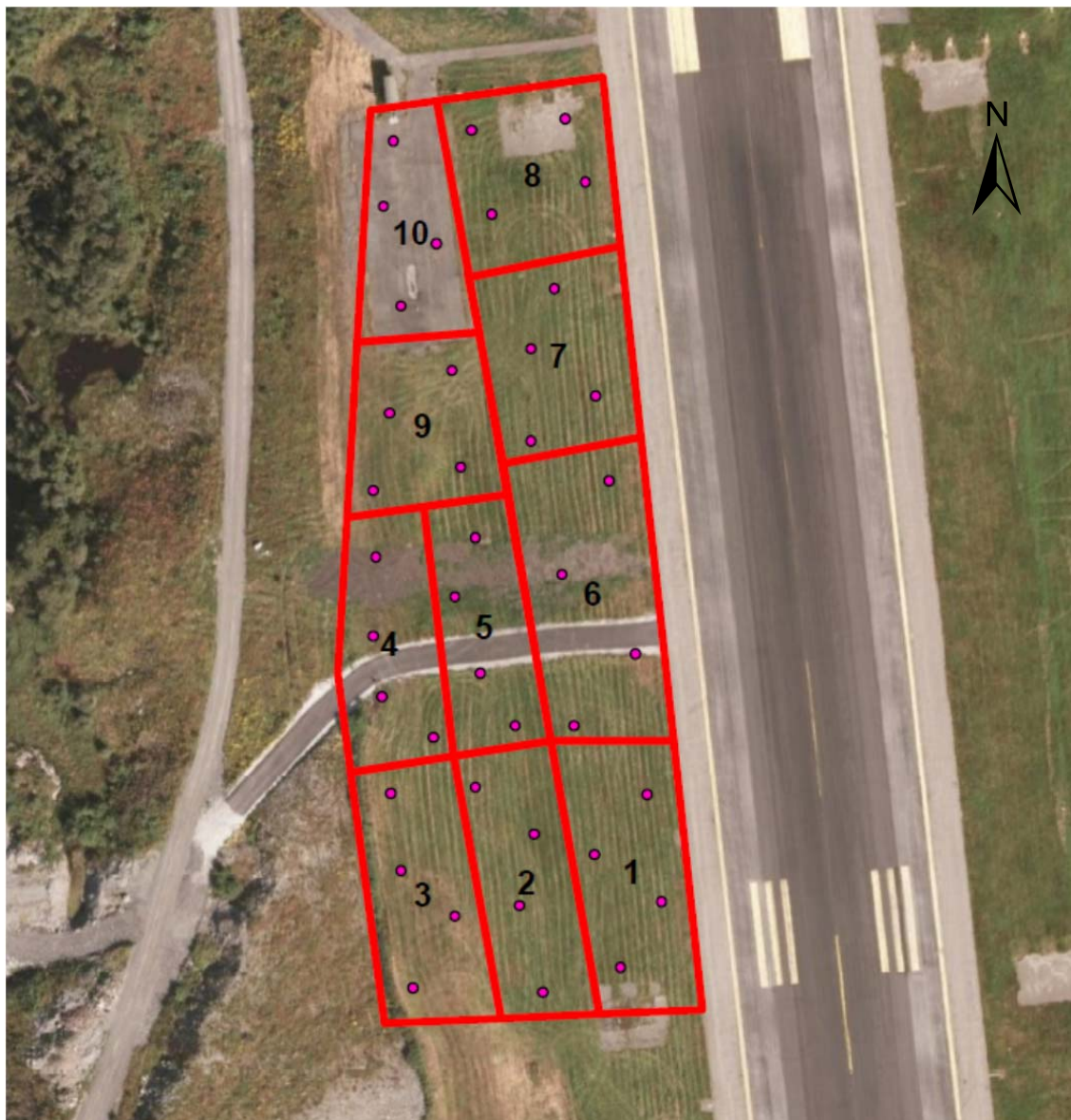
Figur 4. Prøvetakingsplan for glidebane 35. Rosa punkt er prøvepunkt. Felt avgrenset med rødt angir hvilke prøver som er blandet til én blandeprøve. Nummerering viser til prøvenr. Det vil si at blandeprøve Bprøve 1 er fra delområde merket 1 osv. Delområde 10 er ikke undersøkt på grunn av asfaltdekke. Kartgrunnlag: geocache bilder.
