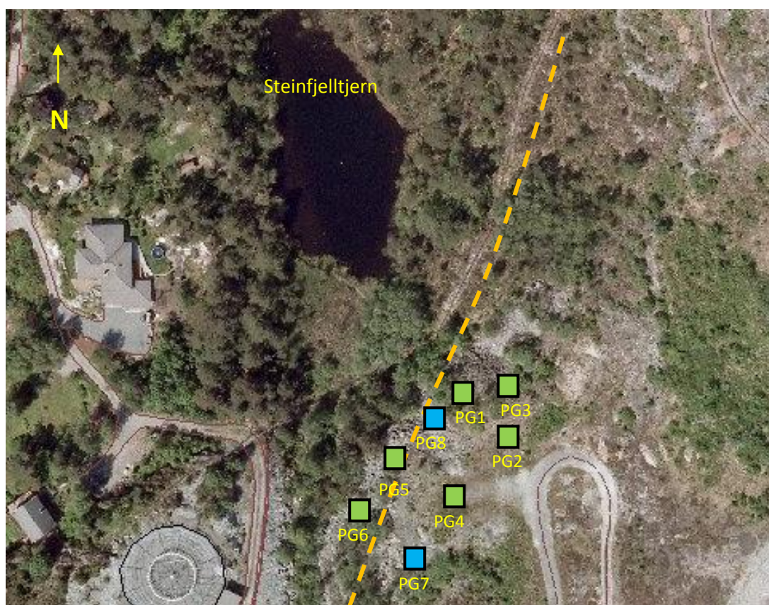
Figur 6.1: Oversiktsbilde over fyllplass nord med prøvegroper inntegnet (omtrentlig plassering). Fargen på prøvegroperne viser høyeste tilstandsklasse påvist for de analyserte kjemiske parametrene. Omtrentlig plassering av den nye evakueringsveien er også avmerket (oransje, stiplet linje). (Kartkilde: www.bergenskart.no ).
