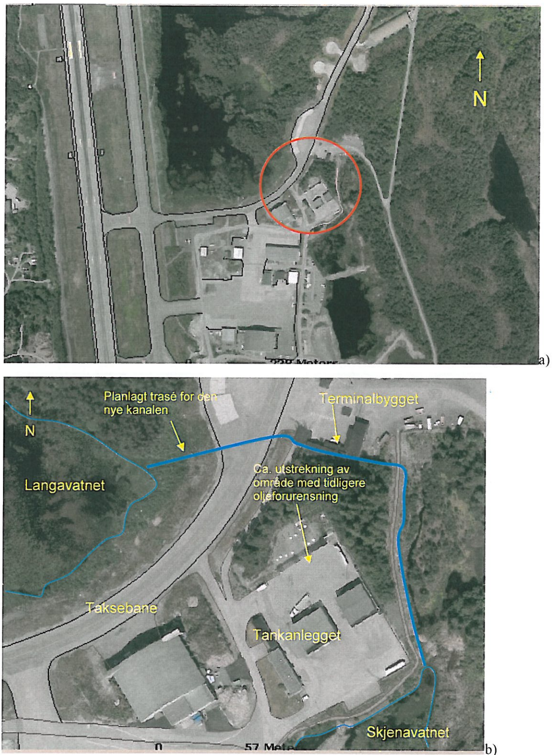
Figur 3.1: a) Oversiktsbilde der aktuelt område er innringet med rødt og b) flyfoto som viser traséen til den nye kanalen samt tankanlegget med området med tidligere oljeforurensning. (Kartkilde: www.bergenskart.no ).
