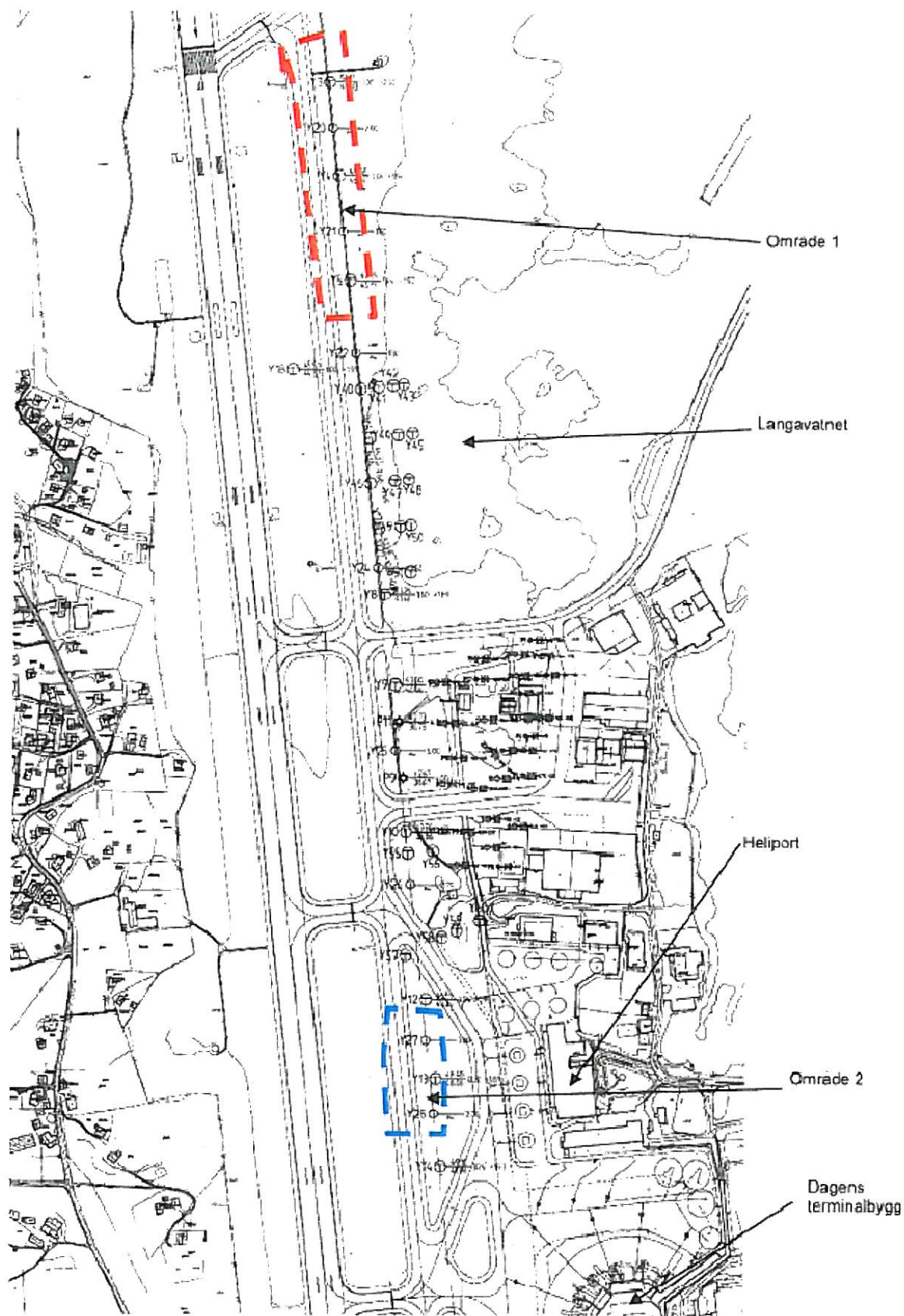
Figur 1: Oversikt over forurensede områder etter at nye normverdier er trådt i kraft. Det skal utføres supplerende grunnundersøkelser for å avgrense område 1 og 2. Dersom arbeidet utføres før de nye normverdiene er trådt i kraft må alle fyllmasser håndteres som forurensete.
