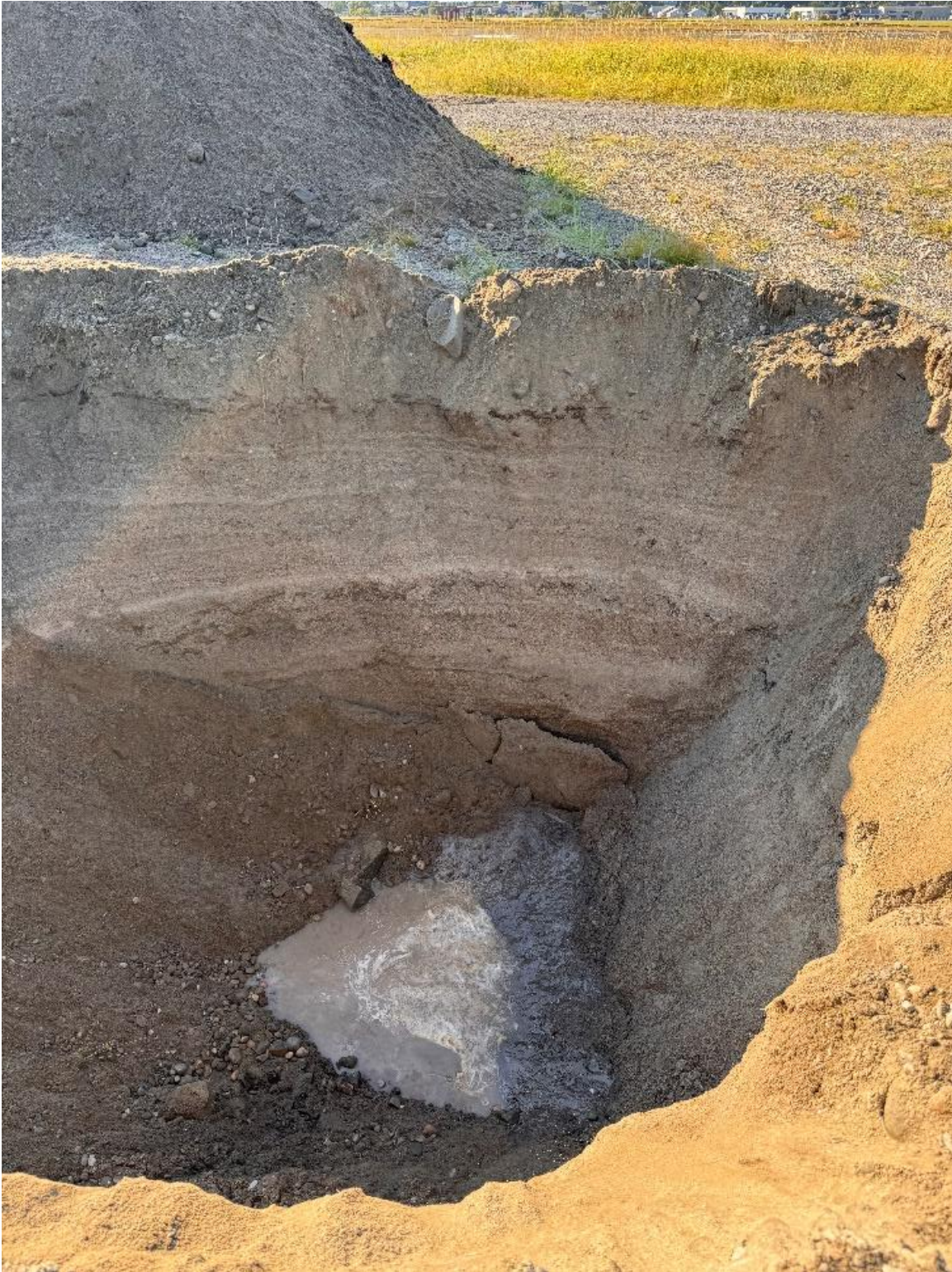
Figur 3-2: Bilde fra PG1 med synlig lagdeling, grunnvann og erosjon/kalving i bunn av gravegrop (foto: Norconsult Norge AS).
