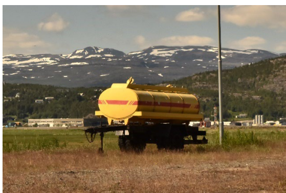
Figur 17. Bilde viser den gamle 10 m 3 tankvogna som ble benyttet til å transportere slukkevanns restene som ble sugd opp fra GUP-tanken inn til hallen med brannbilene på lufthavna.
