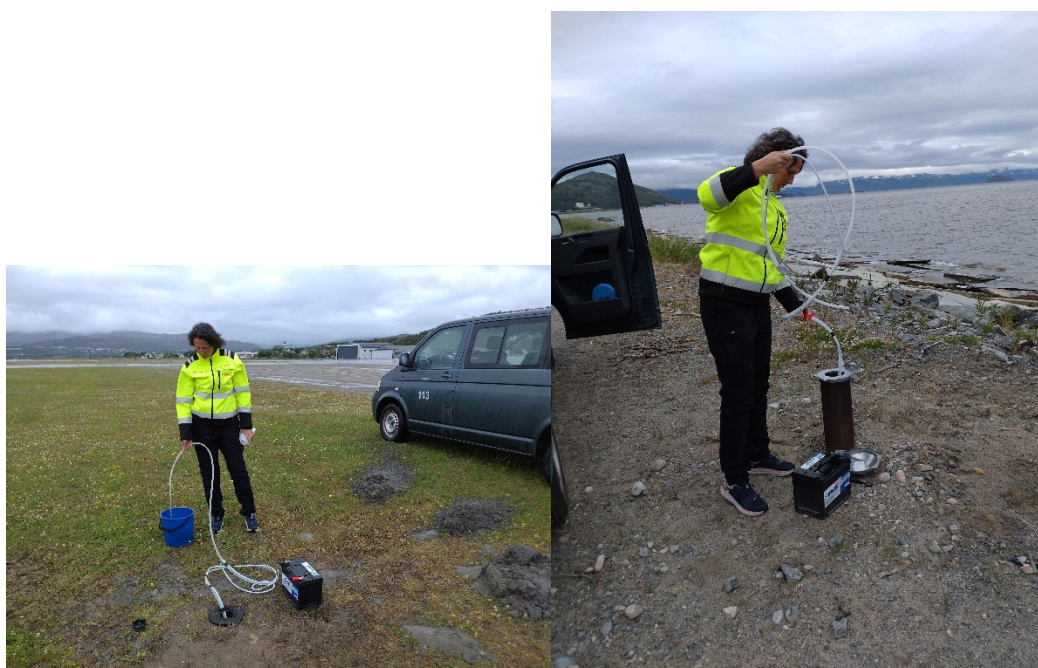
Figur 37. Bilde til venstre viser rensepumping av miljøbrønn ENAT-DB-GL-BR37, og til høyre klargjøres det for rensepumping og prøvetaking i miljøbrønn ENAT-BØF-BR22 ute på Naustneset, juni 2022 (Foto Tom Tellefsen).
