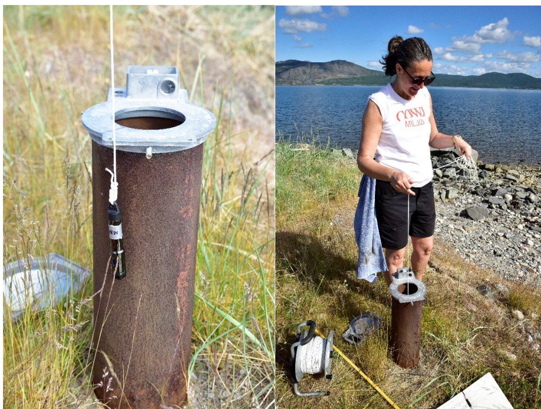
Figur 38. Bilde til venstre viser CTD grunnvannsloggeren som ble satt ned i miljøbrønn ENAT-BØF1-24. Bilde til høyre viser miljøbrønnens plassering i forhold til sjø, og utplassering av "diver" etter ferdig innmålt dyp den 27 juni 2023 (Foto Tom Tellefsen).
