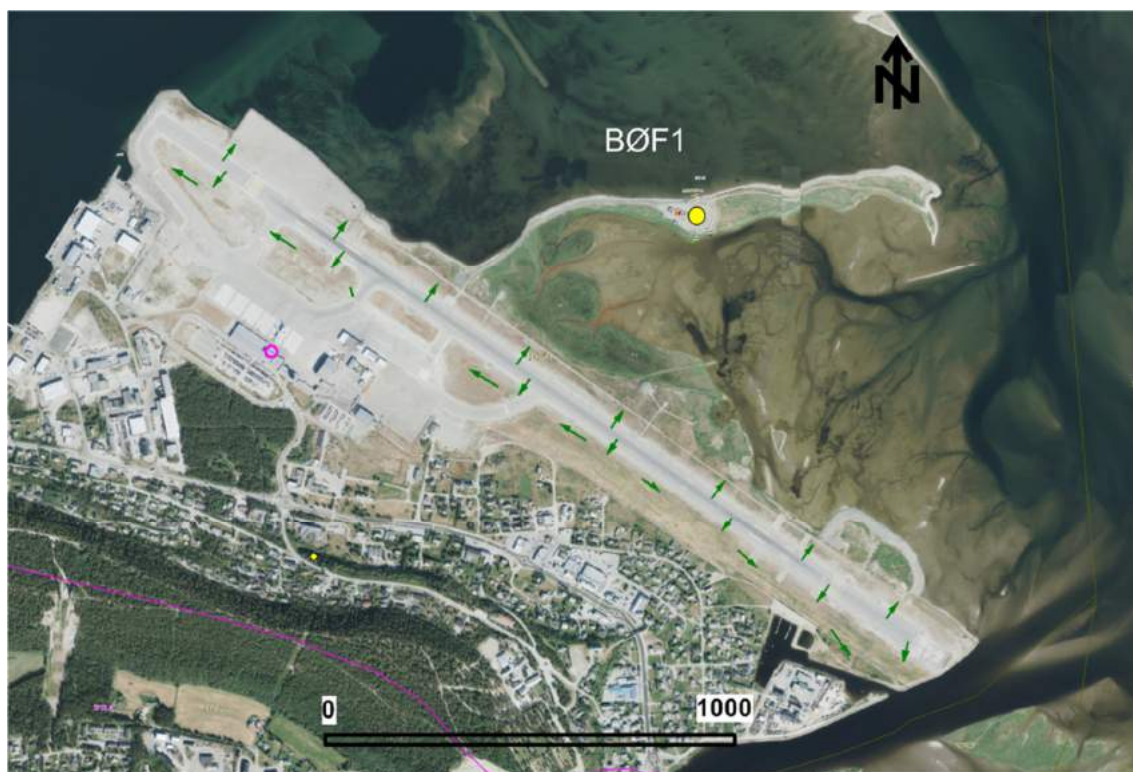
Figur 7-2. Grønne piler viser retning avrenning fra rullebanen. BØF er vist med gul sirkel. Rosa strek som går sør for lufthavnen er vannskille fra NVE Regine.
