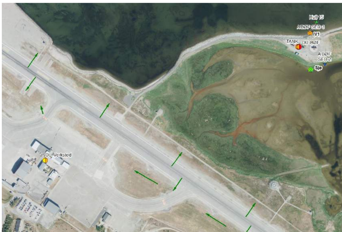
Figur 7-8. Oversikt over BØF og OU-verksted. Grønne piler viser retning avrenning fra rullebanen.
