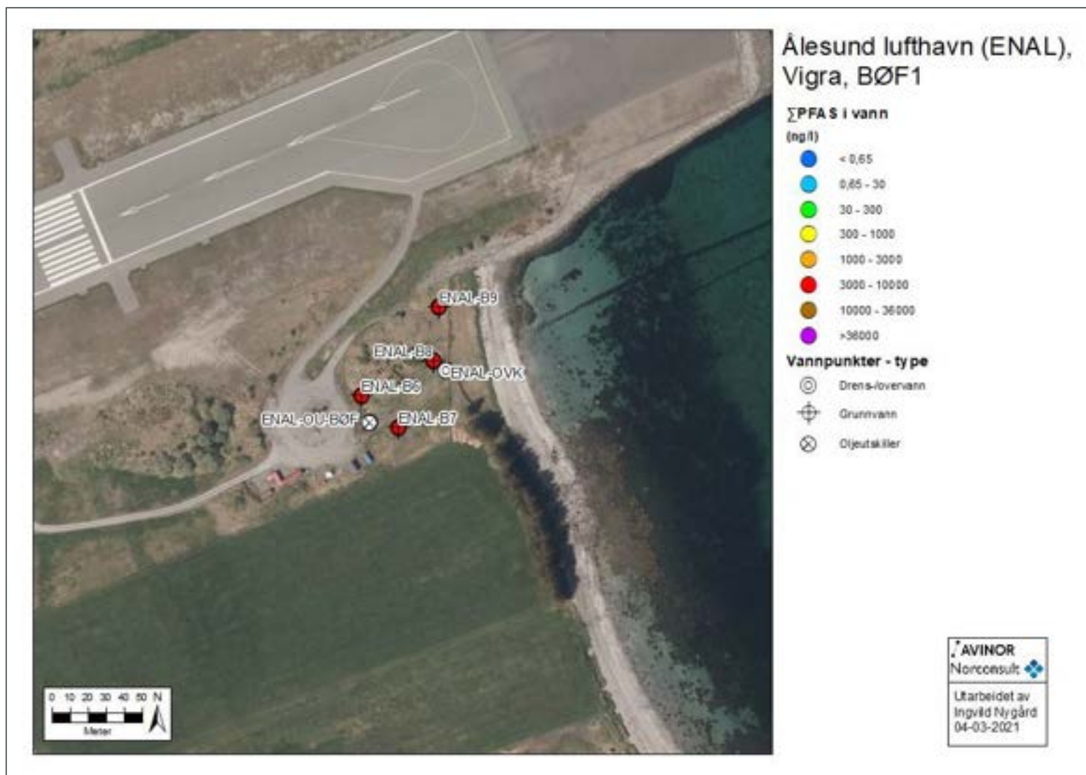
Figur 4-4: Analyseresultater for \Sigma PFAS i vann. Konsentrasjoner er vist som gjennomsnitt for de to prøvene i hver brønn ved prøvetaking 09. september 2020. Punktene OU-BØF og OVK ble ikke prøvetatt i forbindelse med supplerende undersøkelser.
