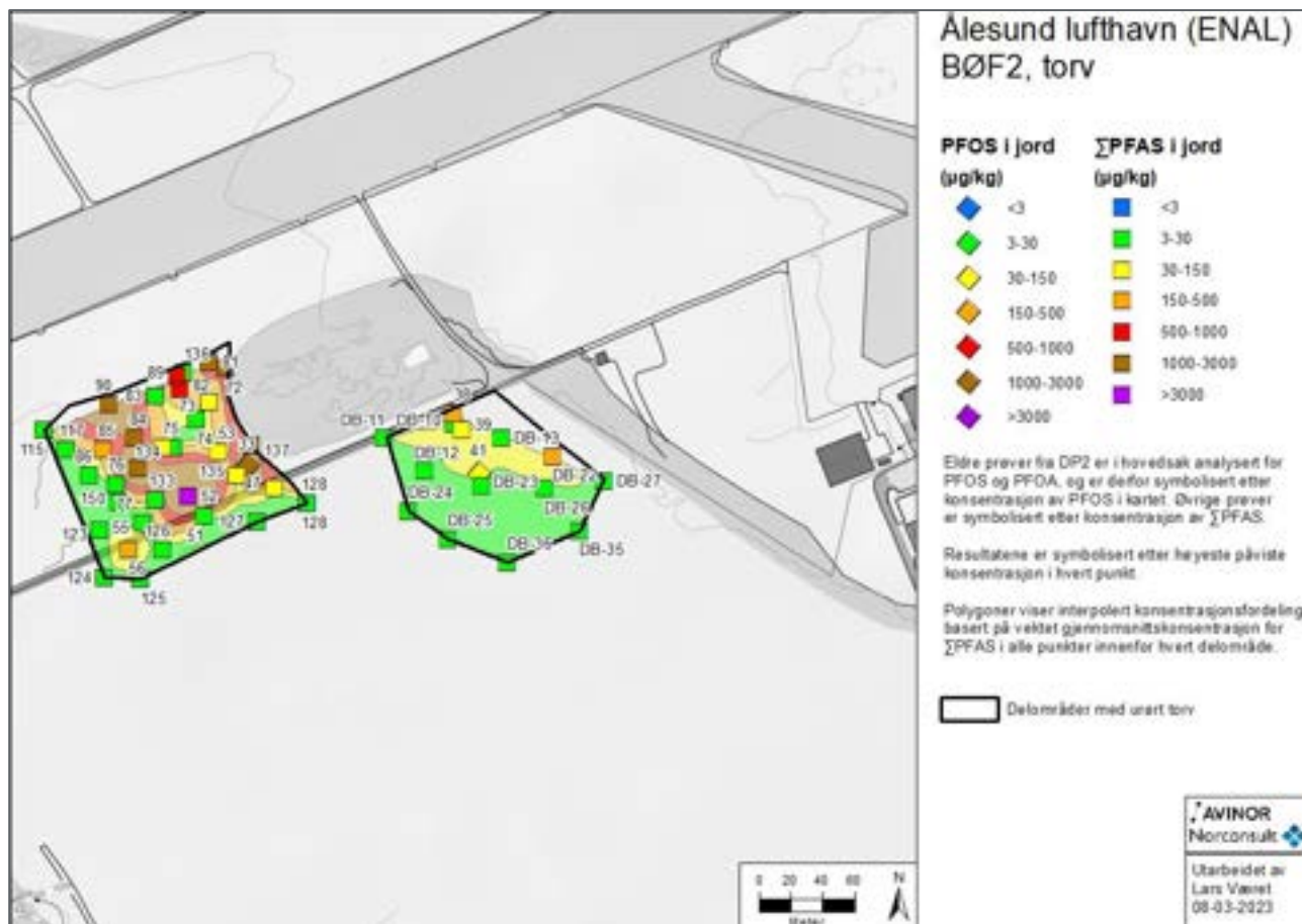
Figur 5-4: Interpolert konsentrasjonsfordeling (µg/kg) for myrområder vest og sør for gammelt brannøvingsfelt (BØF2). Interpolering er utført ved bruk av metoden "natural neighbour" i programvaren Surfer. Sort polygon markerer delområder for utførte mengdeberegninger.
