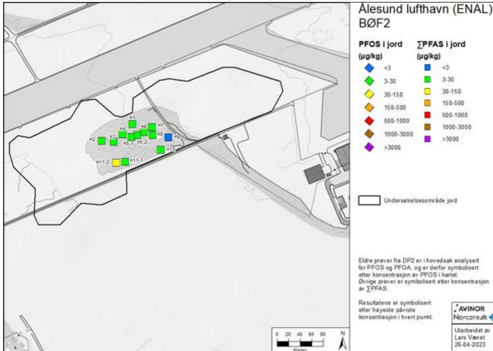
Figur 4-2: Resultat fra prøver av lagrede masser (hauger) på området for BØF2.
