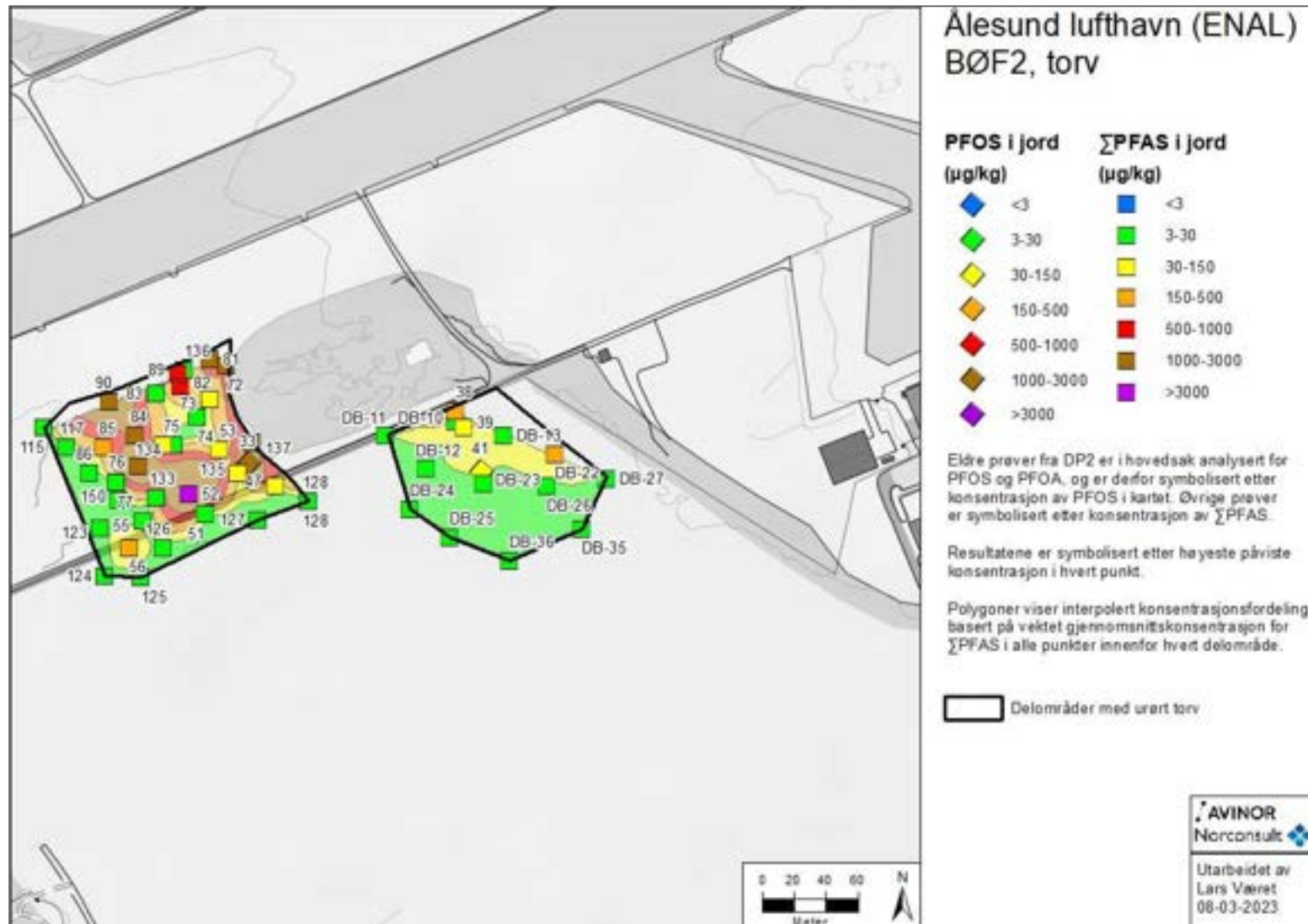
Figur 5-3: Interpolert konsentrasjonsfordeling (µg/kg) for myrområder vest og sør for gammelt brannøvingsfelt (BØF2). Interpolering er utført ved bruk av metoden "natural neighbour" i programvaren Surfer. Sort polygon markerer delområder for utførte mengdeberegninger.
