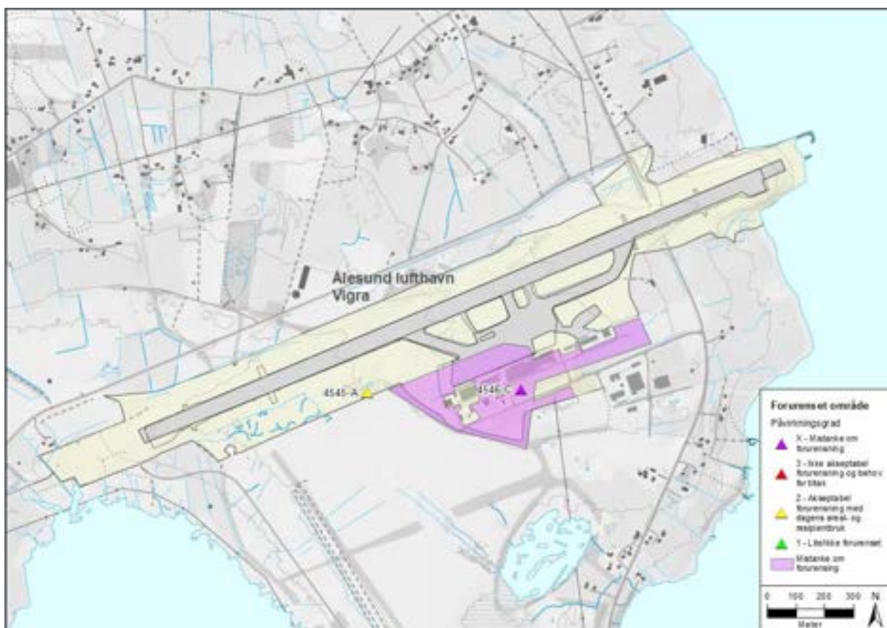
Figur 2-4: Registrerte lokaliteter med forurensset grunn ved Ålesund lufthavn Vigra. Punkt plassering, symbolikk og punkt-ID er hentet fra Miljødirektoratets database Grunnforurensning ( https://grunnforurensning.miljodirektoratet.no/ ).
